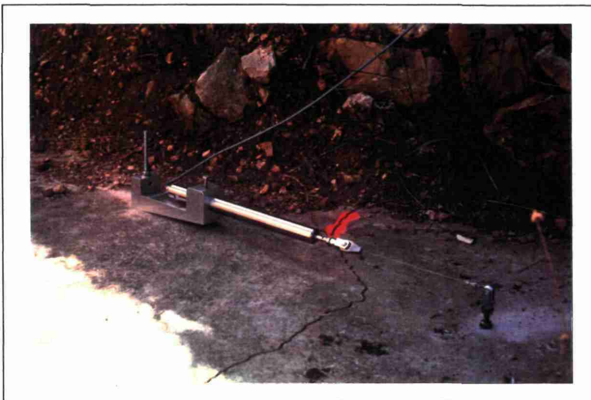
Fig. 14 - Capteur n° 5 : déplacement base courte (100 mm)
