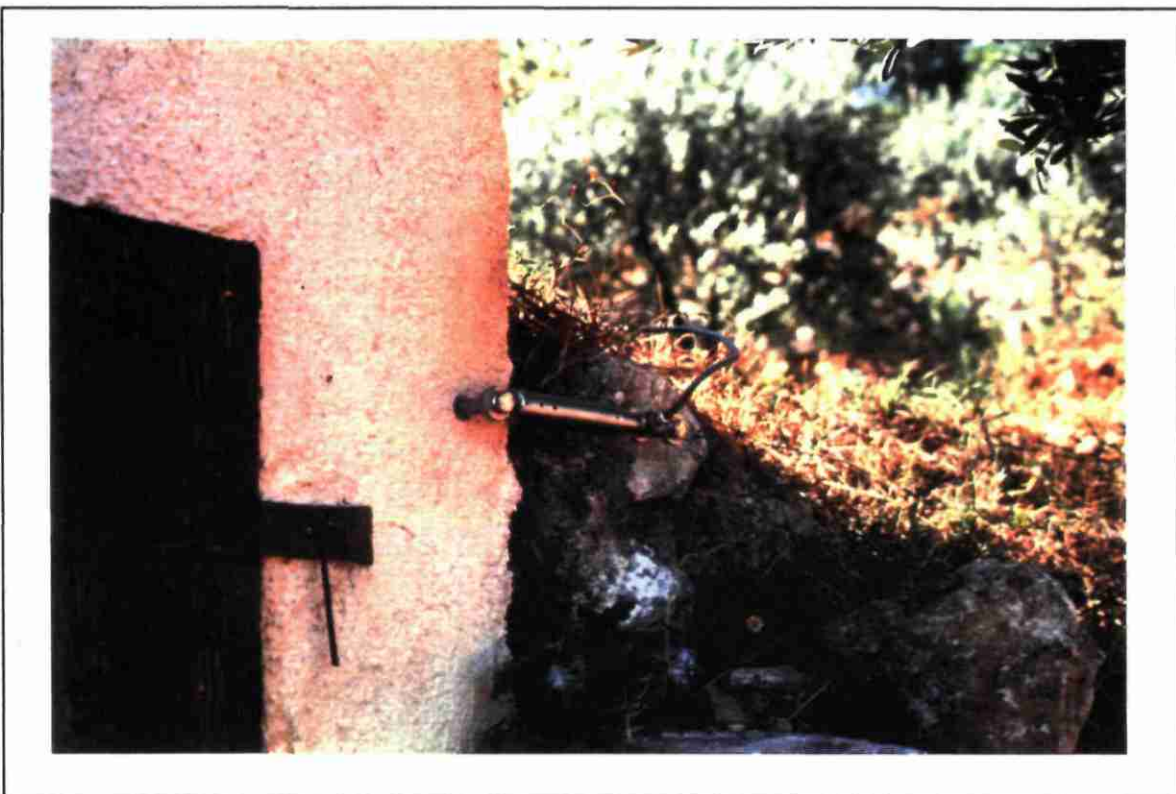
Fig. 8 - Capteur n° 3 : déplacement base courte (50 mm)
