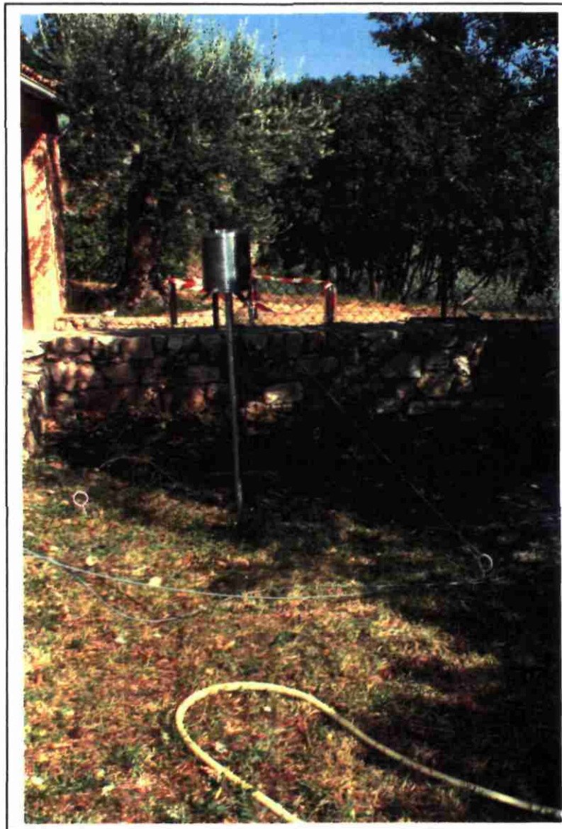
Fig. 16 - Capteur n° 6 : pluviomètre à augets
