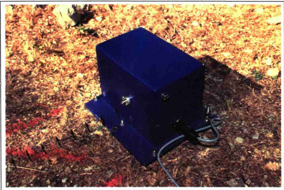
Fig. 12 - Capteur n° 4 : déplacement longue base (5 m)
