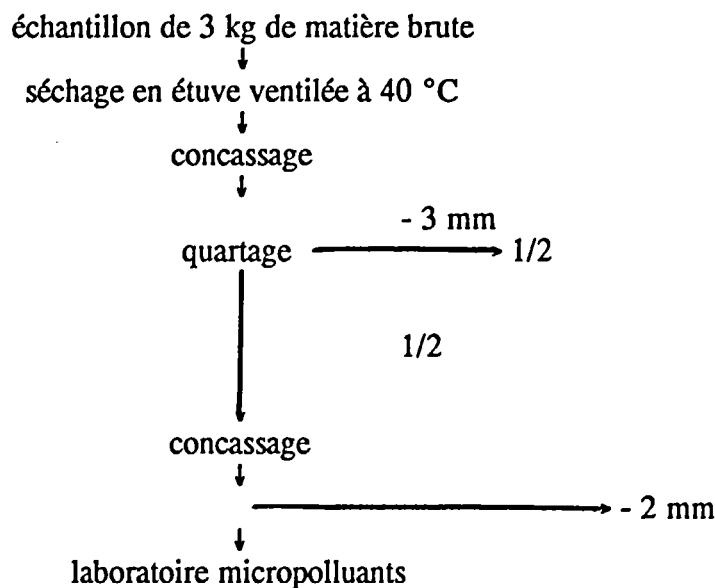
Pour les HPA, 10 à 15 g de solide sont extraits par un mélange dichlorométhane/acétone aux ultrasons dans un rapport 50/50 (opération renouvelée 3 fois).
