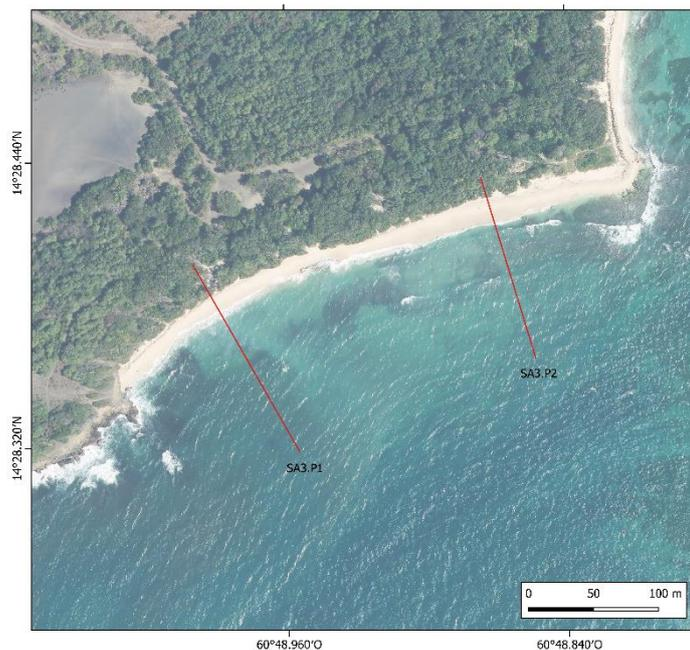
Figure 23 : localisation des profils de référence mesurés avant et après le passage de BRET sur l'anse Baleine au Marin. Fond de carte : orthophoto 2017 (IGN).
