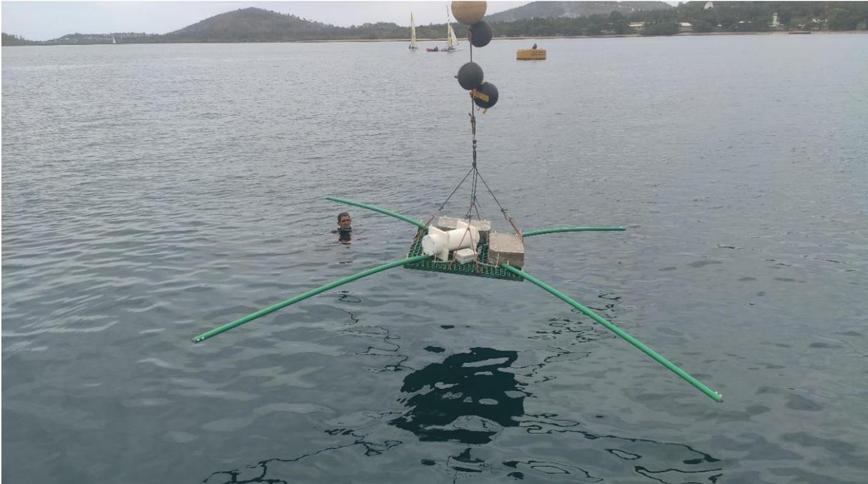
*Figure 31 : Mise à l'eau de la station STATEM. Le plongeur s'assurera de la bonne mise en place (orientation vers le Nord Magnétique et nivellement) de la station sur le fond marin.*
