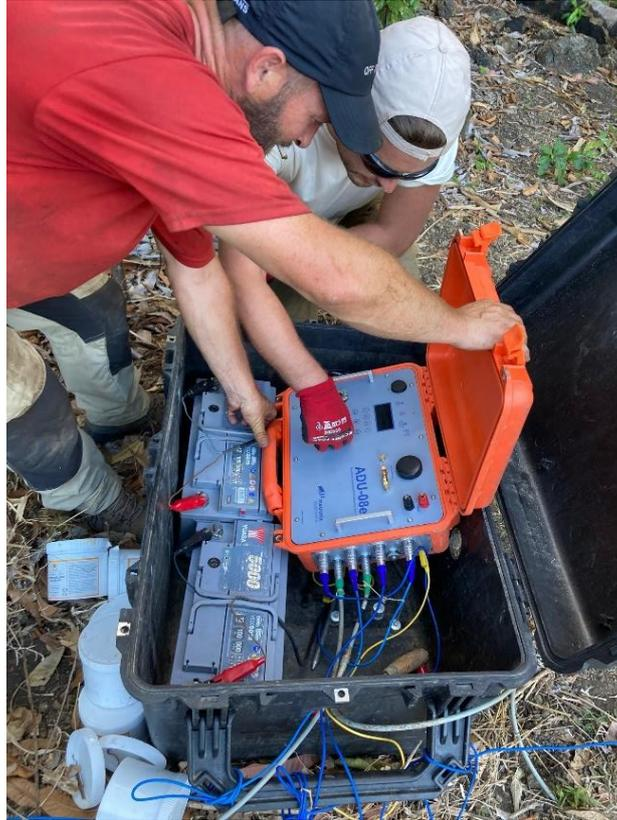
Figure 20 : Installation de l'enregistreur (ADU) sur le terrain. Les batteries fournissent l'alimentation électrique au bon fonctionnement de l'appareil durant la phase d'enregistrement qui dure environ deux jours.
