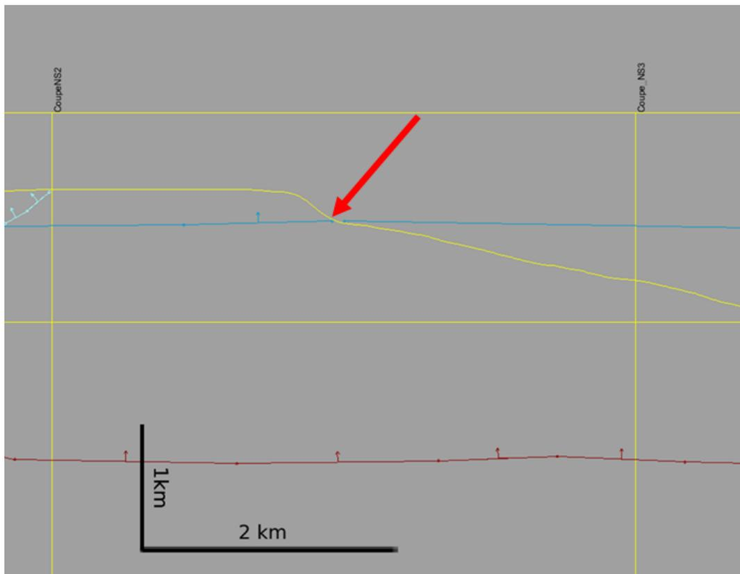
Figure 84 : Emplacement de la rupture de pente qui a servi de point de référence pour placer la base de la barrière corallienne, sur la coupe EW3 (Figure 9), Ouest à gauche.
