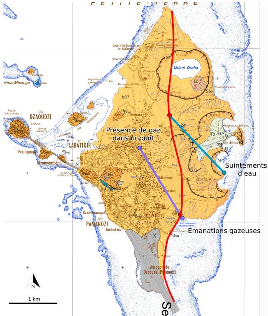
Figure 81 : Emplacement des indices de perméabilité verticale permettant de placer les traces des deux failles. Les points en rouge indiquent l'emplacement des failles sur le profil électrique.
