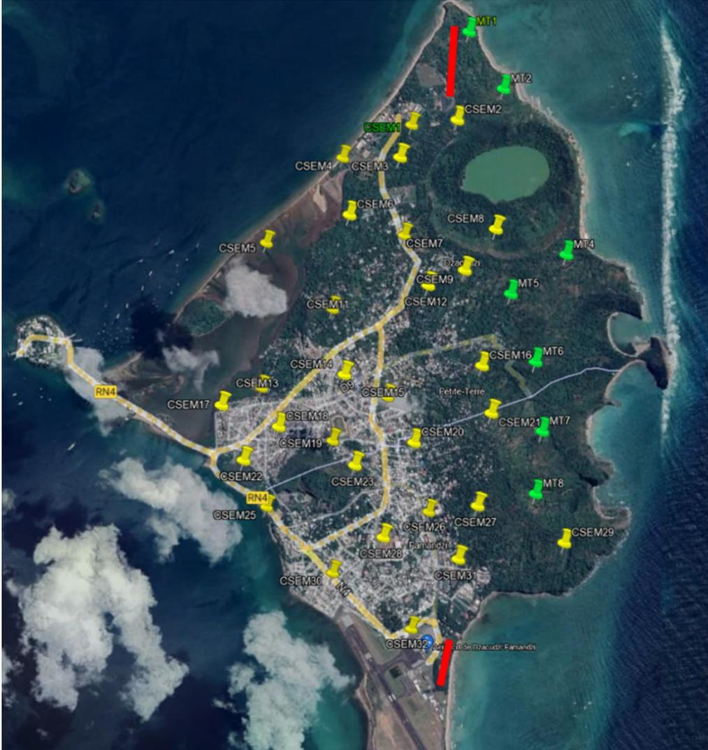
Figure 27 : Carte de la répartition des récepteurs de CSEM (jaune) et des sources (rouge). Les points de MT (vert) sont aussi des points qui seront utilisés pour la CSEM.
