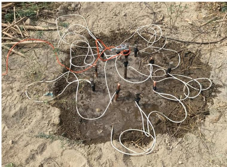
Figure 24 : Exemple de pôle d'injection pour la source sud. On peut observer les différentes électrodes en inox et en cuivre reliées entre elles par des câbles électriques. Le sol est humide après l'ajout d'eau de mer. Le trou fait un diamètre d'environ 1 mètre.
