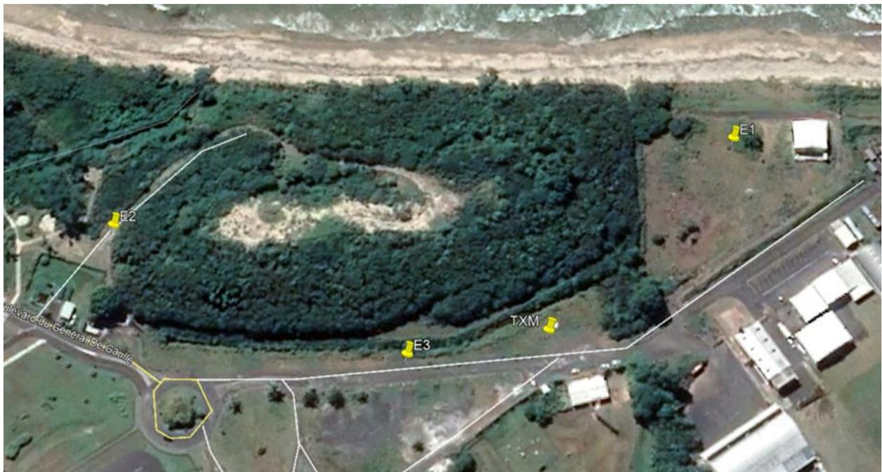
Figure 22 : Source du Sud, TX1. Le générateur est localisé au point TXM. Le dipôle est formé par les pôles E1 et E2. Le pôle E3 correspond à une électrode nécessaire au bon fonctionnement de l'appareil injectant le courant.
