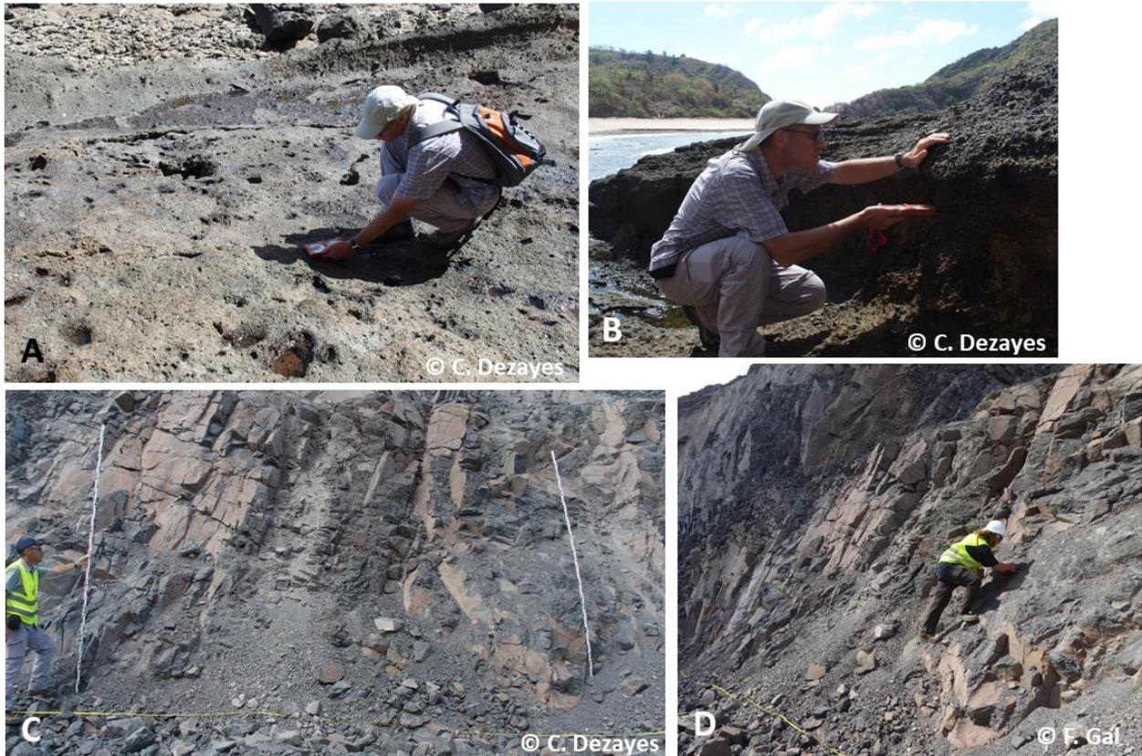
Figure 2 : Aperçu des mesures de fracturation sur affleurements. A : Mesure de direction sur platier ; B : Mesure d'orientation (direction + inclinaison) sur affleurement ; C : Échantillonnage unidirectionnel selon la méthode scanline avec mire de repérage sur photos ; D : Repérage et mesure de l'orientation des fractures le long de la scanline.
