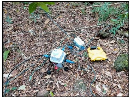
Figure 26 : Schémas d'un système de réception et photo du RAU où les électrodes sont connectées. Au total, quatre électrodes alignées suivant les axes Nord-Sud et Est-Ouest, si possible, sont utilisées.
