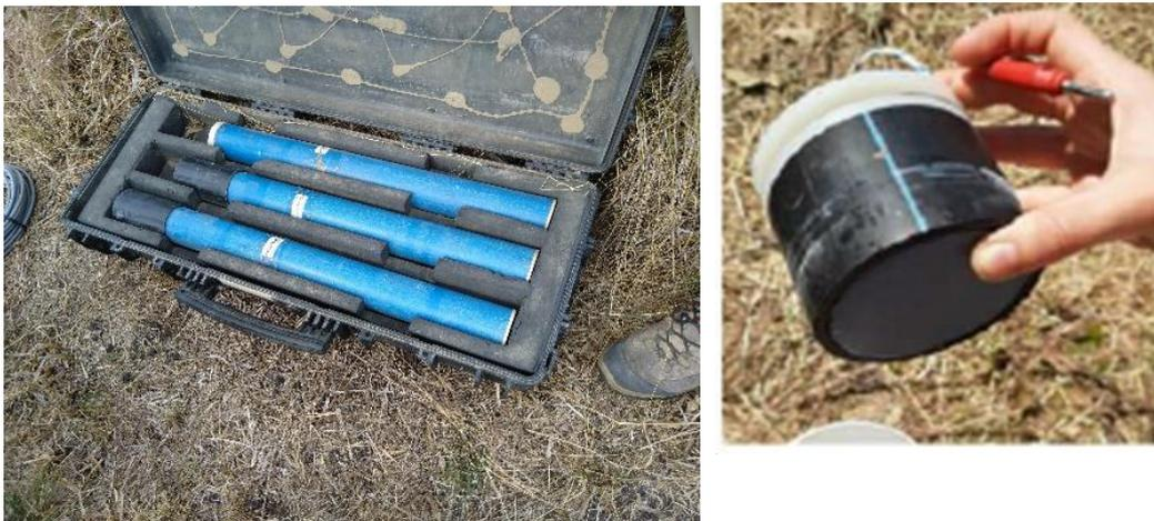
Figure 19: Capteurs pour mesurer le champ magnétique (à gauche) et électrodes pour mesurer le champs électrique (à droite).
