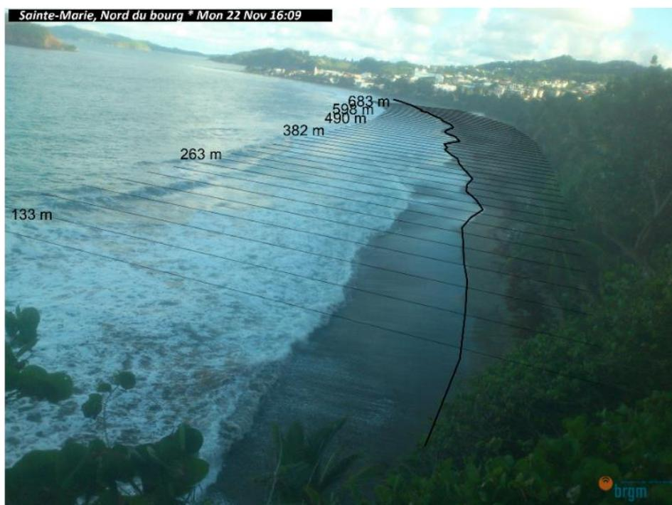
Figure 16 : résultat de la détection automatique de la position du trait de côte (trait noir) sur la plage du bourg à Sainte-Marie. La position des différents transects ainsi que la distance latérale associée (dans l'axe parallèle à la côte) sont superposées sur l'image.
