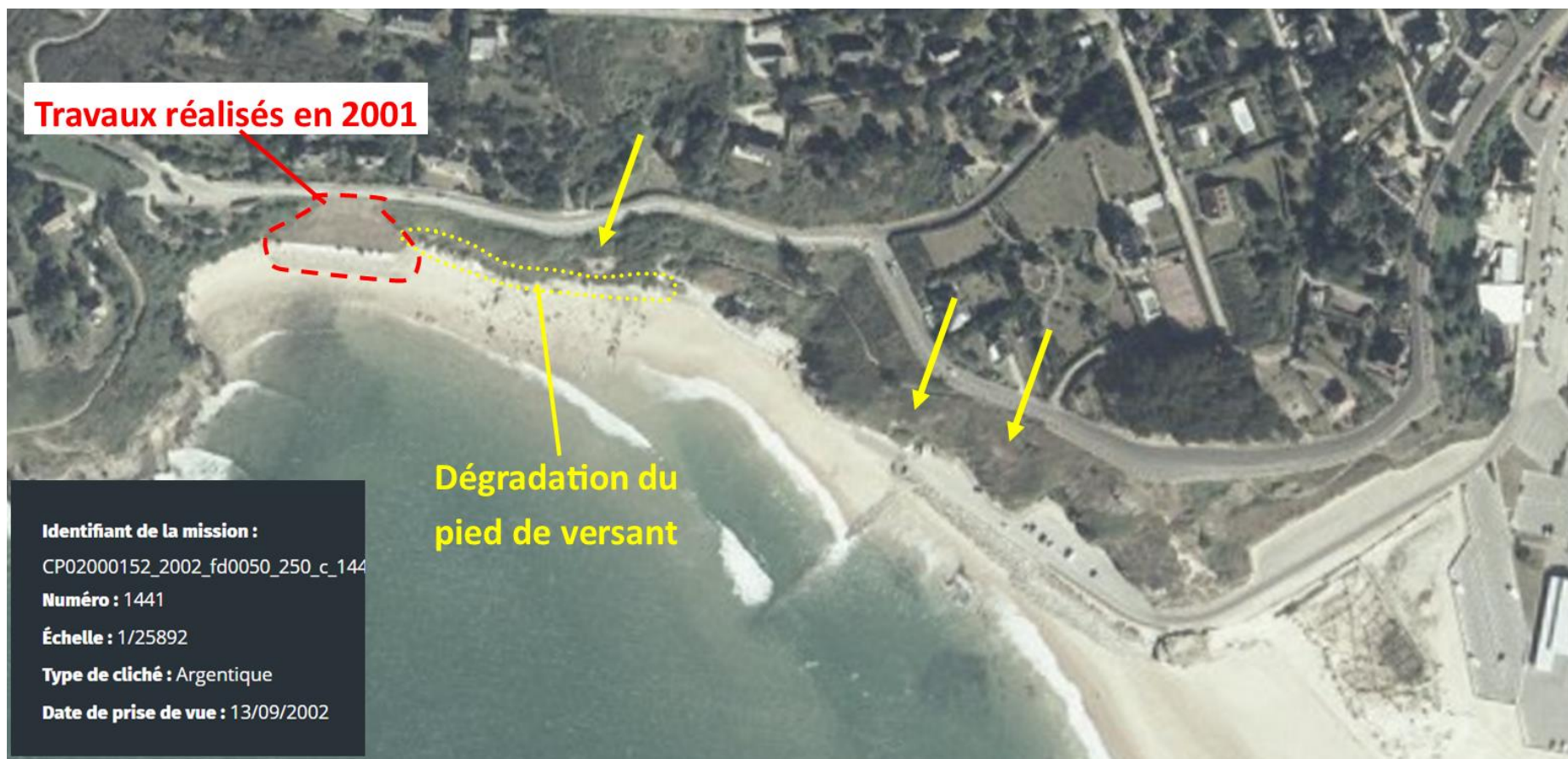
Illustration 23 : Photographie aérienne IGN de 2002, les flèches jaunes matérialisent l'emplacement de loupes de glissement
