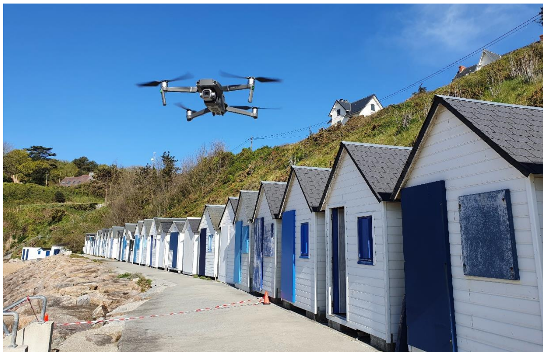
Illustration 49 : Drone utilisé pour les deux campagnes d'acquisition photogrammétriques
