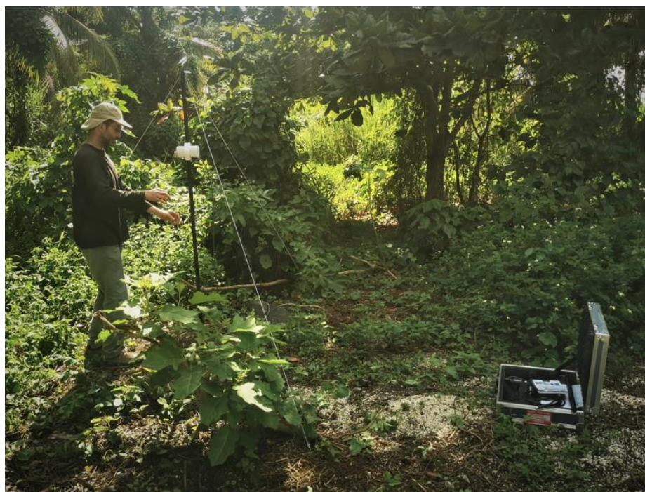
Figure 3 : Installation de la base magnétique GSM19-T utilisée pendant les levés drones pour l'enregistrement des variations temporelles du champs magnétique.
