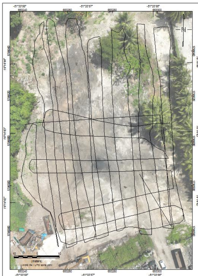
Figure 6 : Plan de de position réalisé au sol à 50 cm de hauteur, couvrant en détail la parcelle découverte, dans un but de recouplement de la cartographie obtenue par drone.
