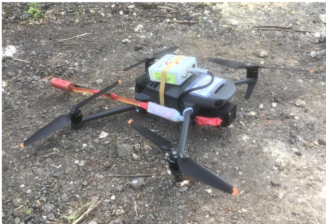
Figure 2 : Drone Mavic 3 équipé d'un magnétomètre fluxgate, utilisé pour réaliser le levé magnétique sur la zone d'étude
