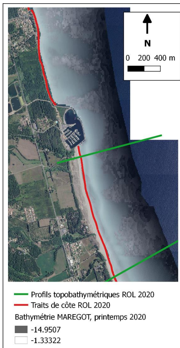
Figure 8 : Données de terrain : données acquises en 2020 dans le cadre du ROL sur le site de « Campoloro » (ces données sont acquises chaque année) et données bathymétriques acquises au printemps 2020 dans le cadre de MAREGOT.
