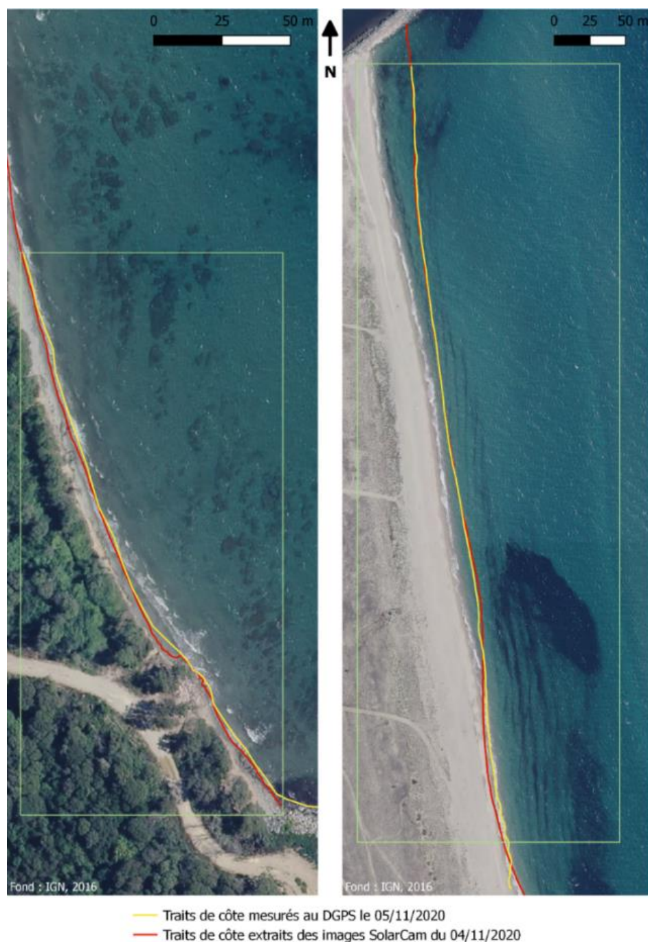
Figure 37 : Zones exploitables des images Solarcam. Les rectangles verts représentent l'étendue des zones dans lesquelles les traits de côte mesurés in-situ et extraits des images Solarcam sont concordants.
