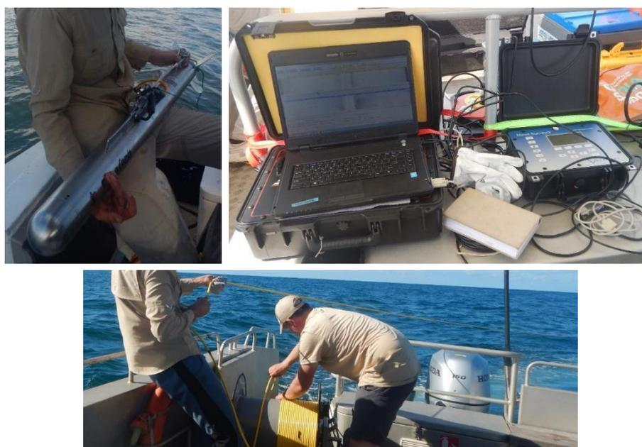
Figure 20 : Déploiement du sonar le long d'un câble de 150 m à l'arrière du bateau et acquisition auprès de l'ordinateur de contrôle ; en haut à gauche : Sonar à balayage latéral ; en haut à droite : PC d'acquisition sonar ; en bas : manœuvre de remontée du sonar (BRGM, 2020).
