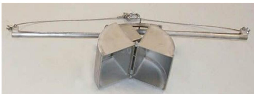
Figure 22 : Benne VanVeen
