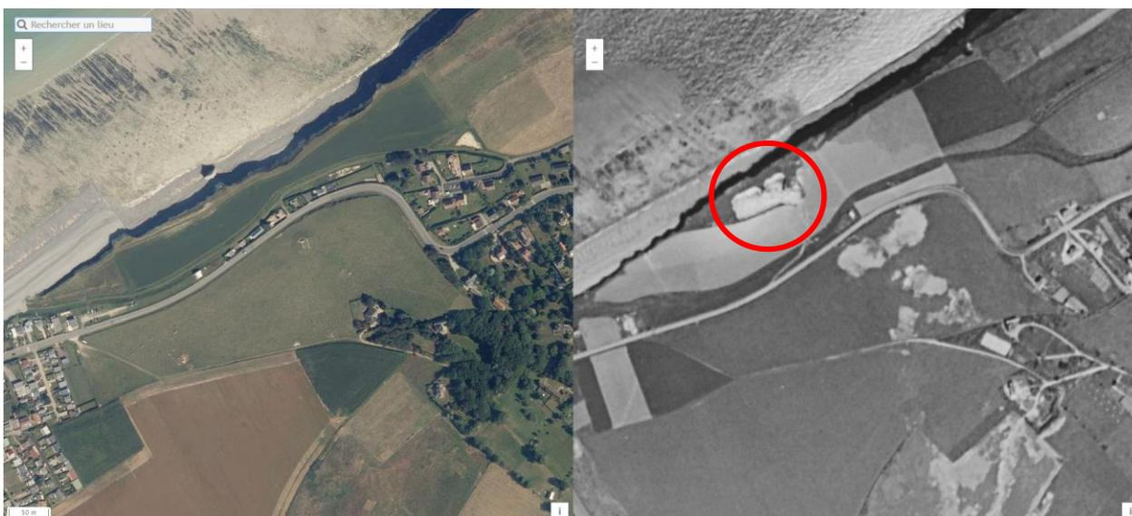
Figure 5 - Comparaison entre une image aérienne récente (à gauche) et ancienne (1960s, à droite) permettant d'identifier un terrain mis à nu correspondant à une ancienne décharge en bord de mer (Source : IGN)
