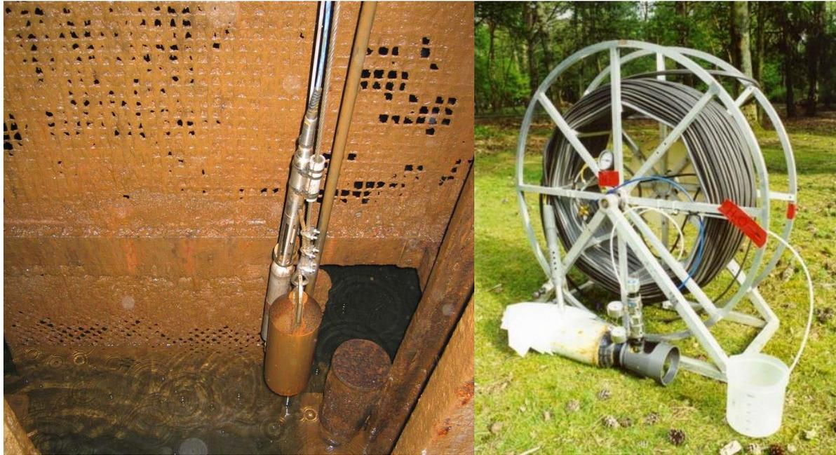
Figure 5 – Photo de gauche : système complet de monitoring en puits minier profond comprenant un échantillonneur « pneumatique » de conception BRGM et une sonde de mesure de la conductivité en continu. Photo de droite : échantillonneur mobile d'une capacité de 300 m.
