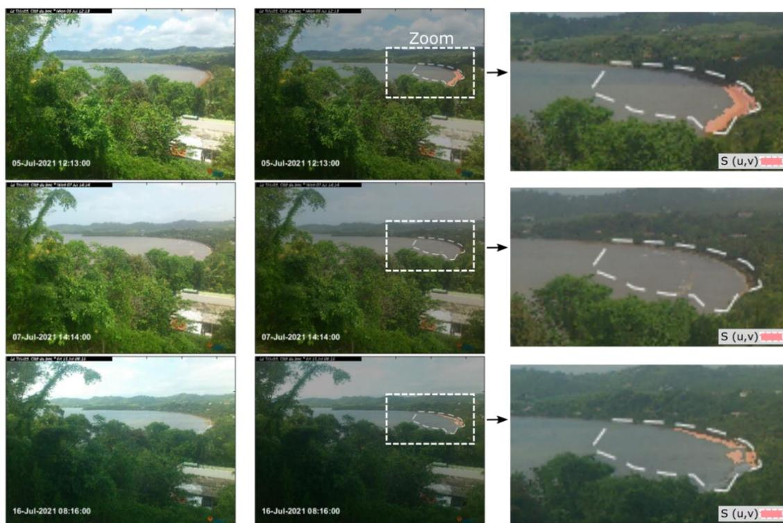
Figure 26 : détection automatique des sargasses  $S(u,v)$  sur la plage de Cité du bac (La Trinité) à différentes dates et pour des quantités de sargasses variables en 2021.
