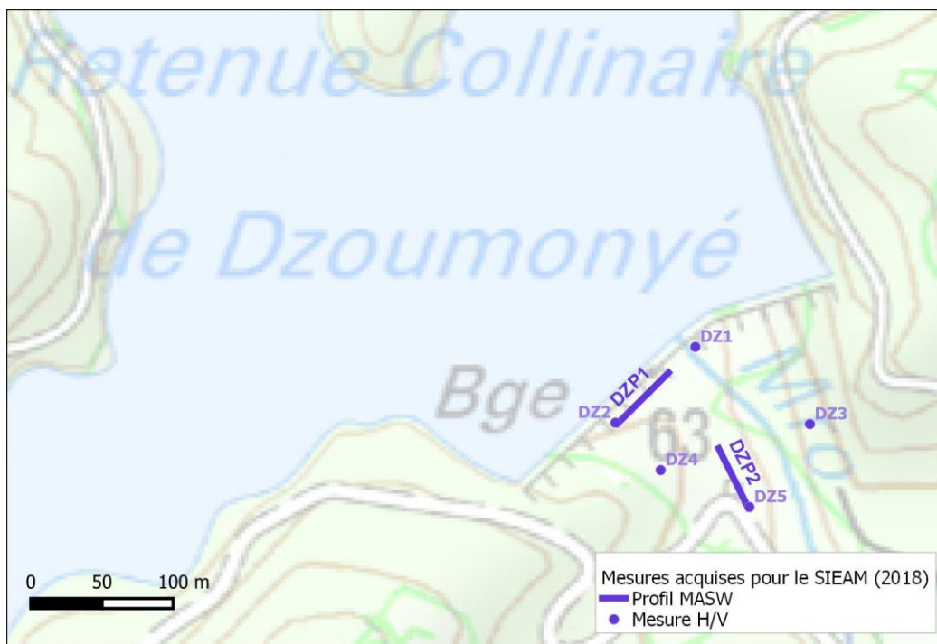
Figure 68 : Localisation des mesures H/V et des profils MASW acquis en 2018 pour le compte du SIEAM près de la retenue collinaire de Dzoumogné.
