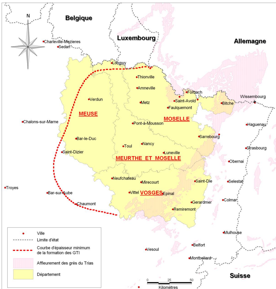
Figure 6 – Extension latérale du réservoir aquifère des Grès du Trias inférieur. D'après VAUTE et al., 2007.
