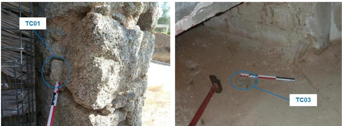
Figure 6 - Points d'échantillonnage du granite porphyrique gris-clair-rosé.
