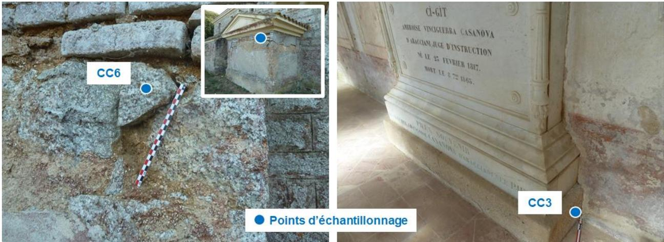
Figure 58 - Points d'échantillonnage du granite gris-clair-rosé à grain grossier.
