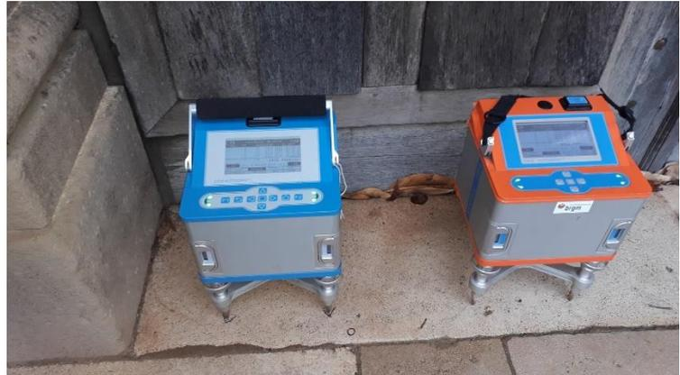
*Illustration 6 : Photographies de la base gravimétrique sur le seuil de l'église, montrant les gravimètres CG-6 en cours de mesure : le #0293 (en bleu) en stationnement sur la base, le #006 (en orange) en chauffe.*
