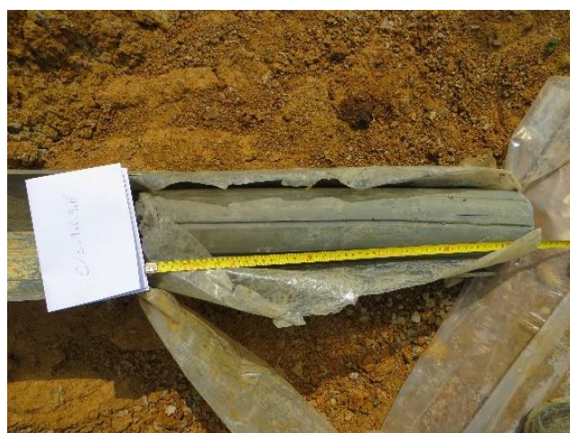
Figure 10 : Type de carotte extraite avec un forage Sonique.
