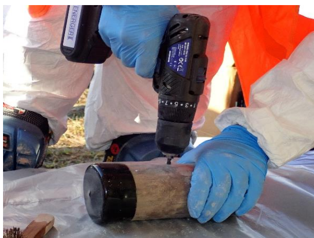
Perçage de la gaine pour effectuer la mesure PID
