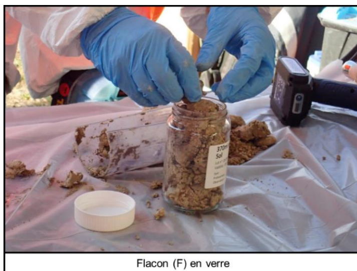
Figure 16 : Échantillonnage réalisé avec un flacon en verre brut.
