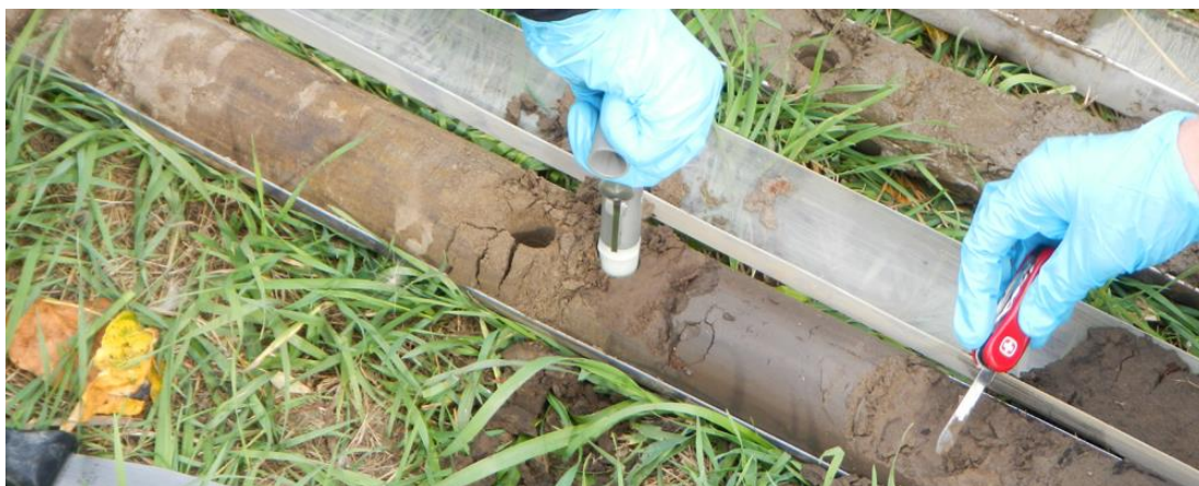
Figure 13 : Collecte d'un échantillon de sol avec un échantillonneur à usage unique (capsule hermétique en téflon)
