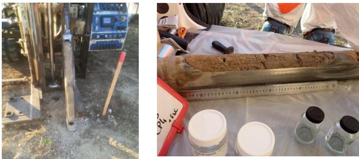
Figure 7 : Sondage réalisé au carottier à gouges (à gauche) et examen de la gouge (à droite).
