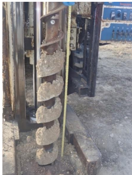
Figure 8 : Sondage réalisé à la tarière mécanique (à gauche) et remontée des sols avec la tarière (à droite).
