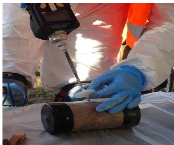
Mesure PID sous gaine
