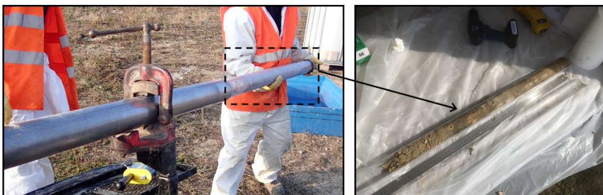
Figure 6 : Sondage réalisé au carottier sous gaine – Extraction de la carotte (à gauche) et ouverture de la gaine (à droite).
