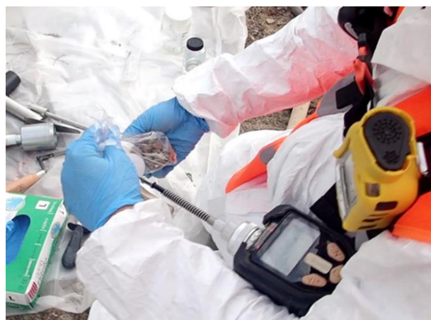
Mesure PID en sac (sols prélevés à la tarière)
