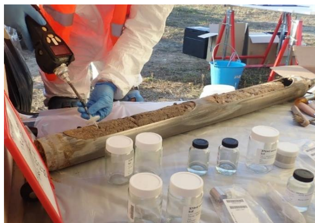
Mesure PID sur une gouge
