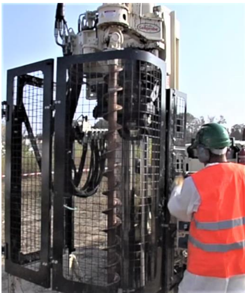
Figure 8 : Sondage réalisé à la tarière mécanique (à gauche) et remontée des sols avec la tarière (à droite).
