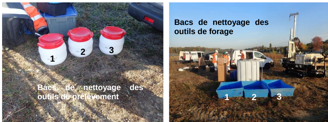
Figure 18 : Illustration d'un dispositif de nettoyage des outils de prélèvement (à gauche) et de forage (à droite).
