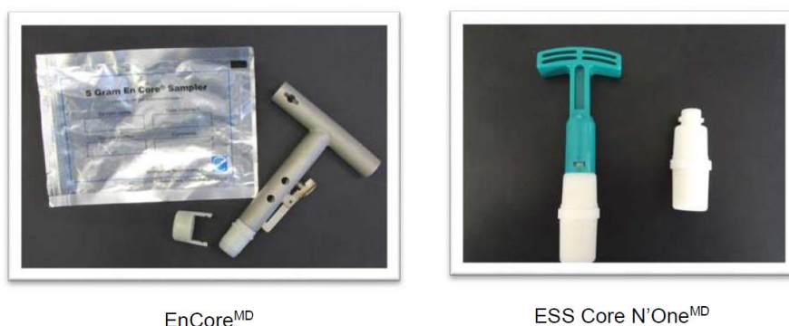
Figure 12 : Échantillonneurs à usage unique (exemple de dispositifs EnCore MD et ESS Core N'One MD ).
