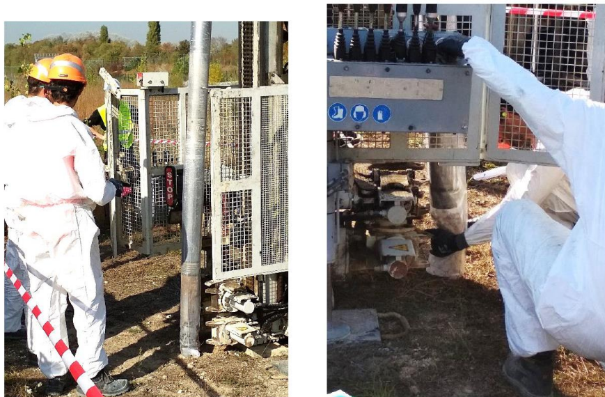
Figure 9 : Sondage réalisé au carottier Sonique (à gauche) - Ensachage de la carotte (à droite et en bas).
