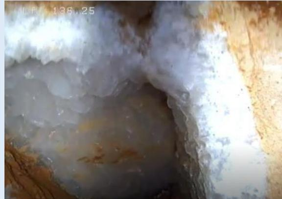
*136 - 137 m : zone avec de nombreuses cavités de section décimétrique dont les parois sont en grande partie tapissées de cristaux de calcite automorphe (vue axiale et vue latérale)*
