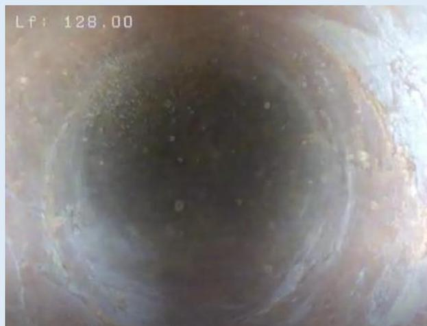
*128 m : zone saine, non fracturée, adaptée à la mise en œuvre de l'ombrelle de cimentation*
