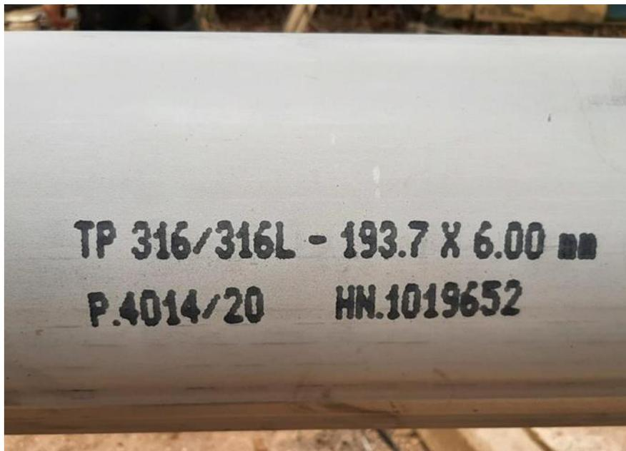
Figure A- 26 : Marquage du tubage inox 316 L Ø 193,7 mm ep. 6 mm
