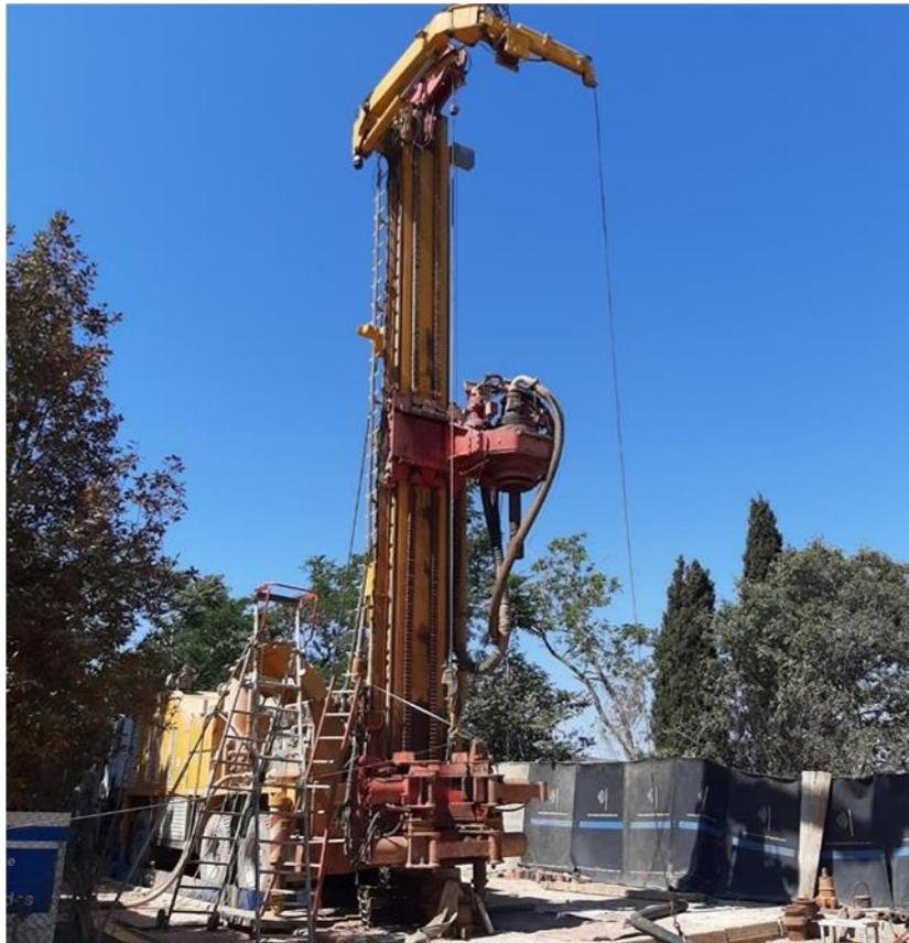
*Figure A- 18 : Atelier de forage destructif d'Hydroforage*
