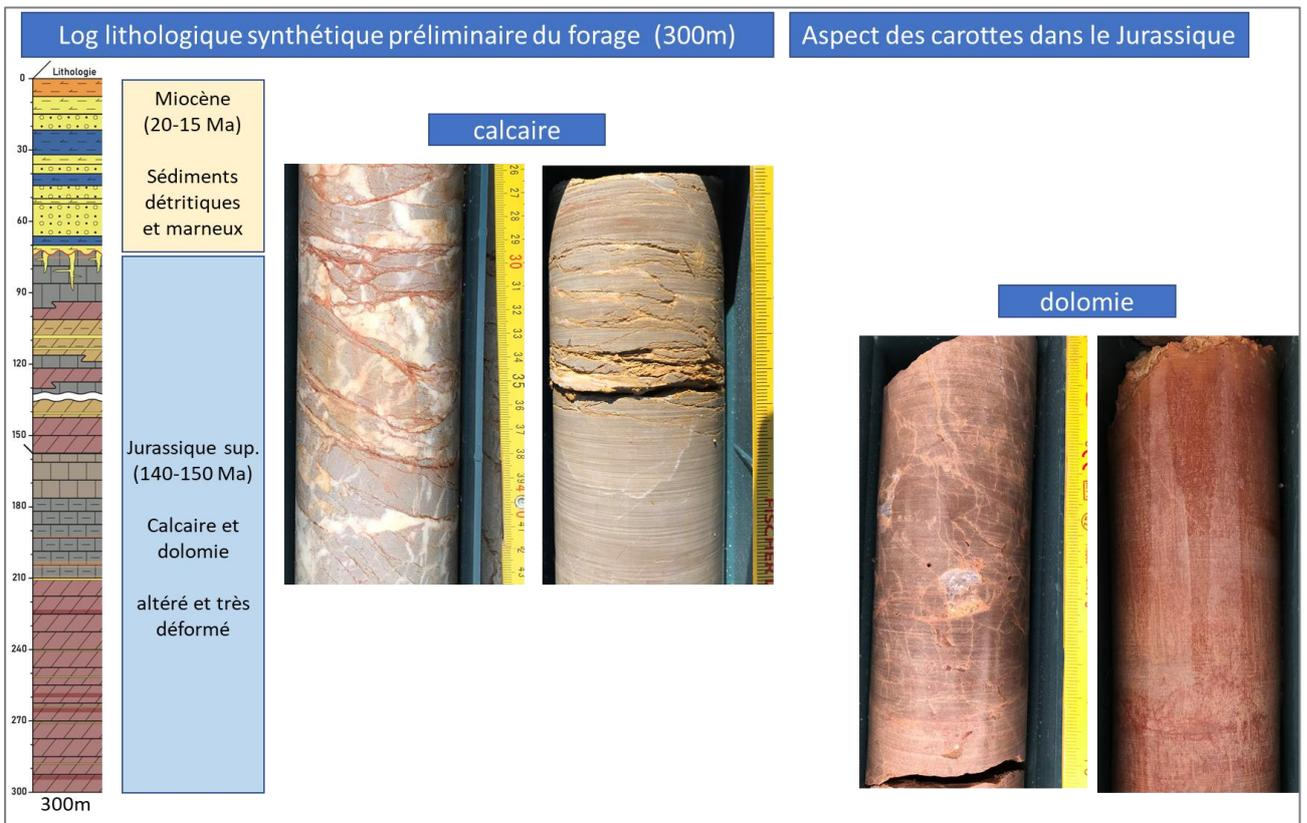
Figure 20 : Log lithologique synthétique préliminaire de l'ouvrage DemT3
