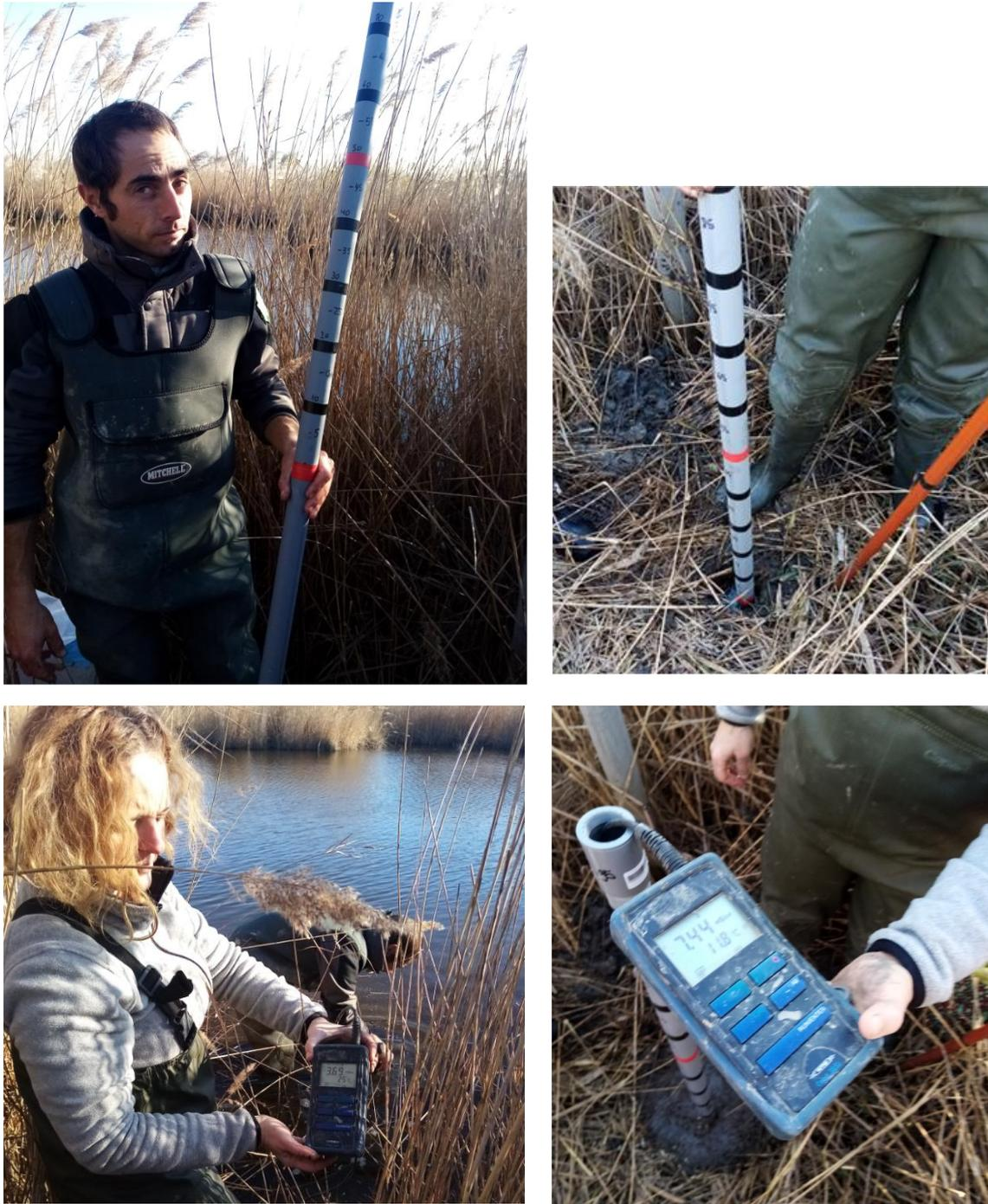
*Illustration 54. Mise en place du piézomètre (30/11/2020), mesure de la conductivité électrique dans le piézomètre et les canaux de surface (amont à gauche et aval à droite de la martelière).*
