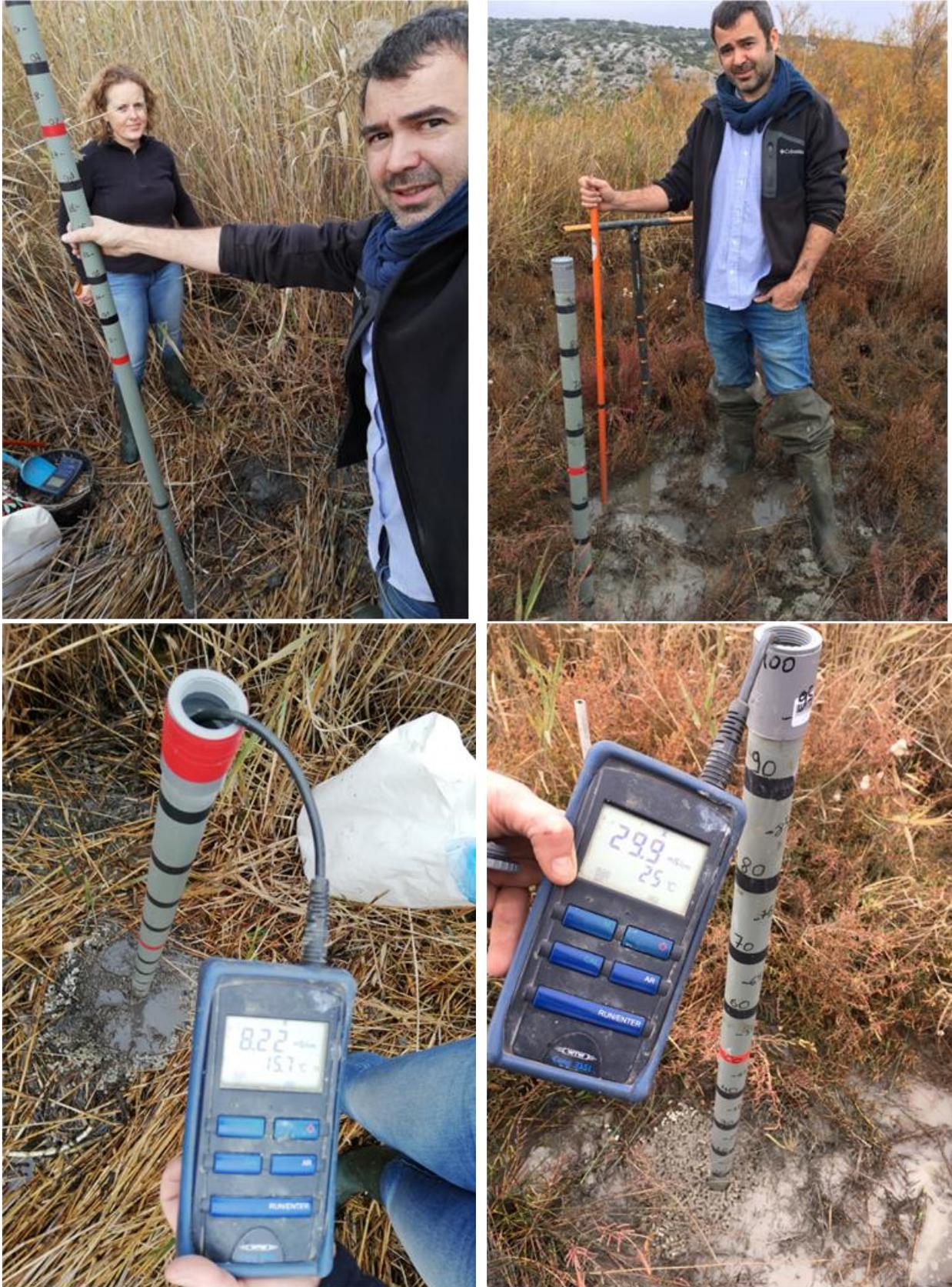
*Illustration 14. Réalisation des piézomètres Sud (à gauche) et Nord (à droite) et conductivité électrique mesurée.*
