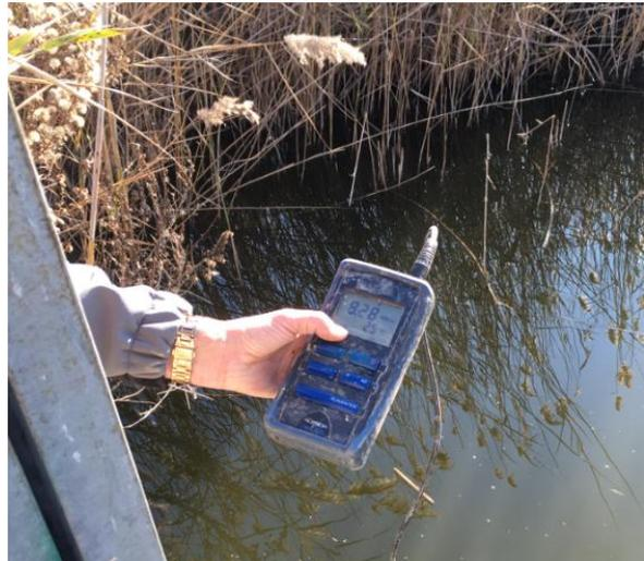
*Illustration 41. Mise en place du piézomètre dans la roselière de la Réserve (site du Méjean) le 30/11/2020. Mesure de la conductivité électrique dans le piézomètre et les canaux de surfaces (amont à gauche et aval à droite de la martelière).*
