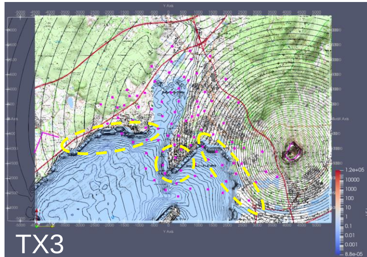
Figure 21 : Niveaux du logarithme de l'amplitude du champ électrique total modélisé à 6m de profondeur sur chaque maille à 128 Hz (peu profond) pour les trois émetteurs. L'effet de la mer est clairement visible avec un resserrement des niveaux à l'interface terre-mer et l'apparition d'effets statiques d'accumulation de charges électriques à l'interface mer-terre. Bathy 0,1m.
