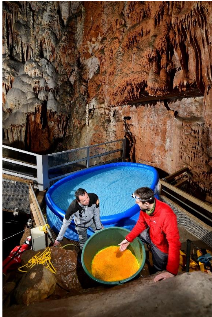
Figure 19 : Dispositif mis en place pour le traçage de l'aven Armand depuis la plateforme (T13) – Ph Crochet.
