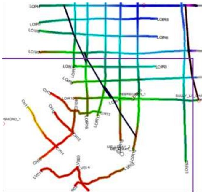
Figure 10 - Carte du pointé de l'horizon correspondant au toit du Trias avec la faille de Sennely (en noir) et l'emprise du géomodèle (en violet).
