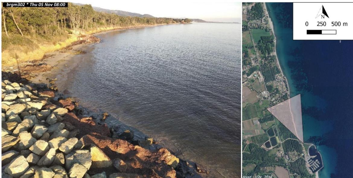
Figure 22 : Emprise photographique de la caméra BRGM 302 utilisée pour le suivi du trait de côte au nord du port de Taverna.
