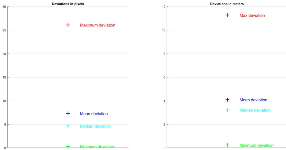
Figure 29 : Valeurs extrêmes, médiane et moyenne de déviation des coordonnées en pixel (gauche) et en mètre (droite) pour la caméra BRGM 301 installée sur la digue Nord.
