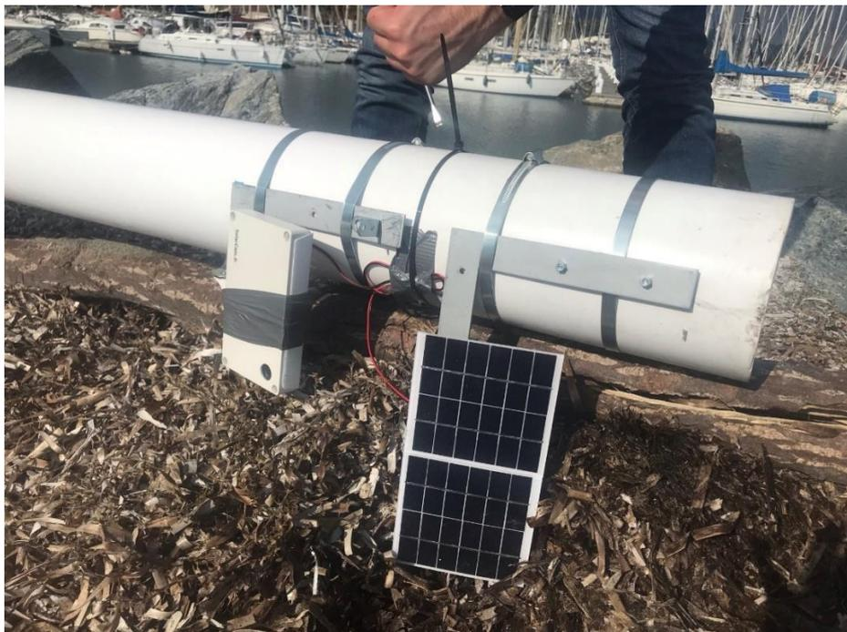
Figure 19 : Fixation des caméras sur le mât de la digue Sud.
