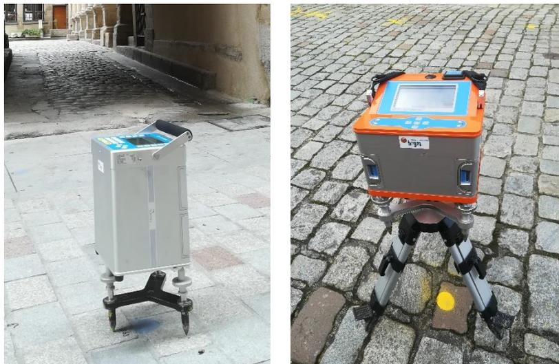
*Illustration 5 – Photo d'un gravimètre CG-5 sur son trépied bas (gauche) et d'un gravimètre CG-6 sur trépied bas et haut (droite).*
