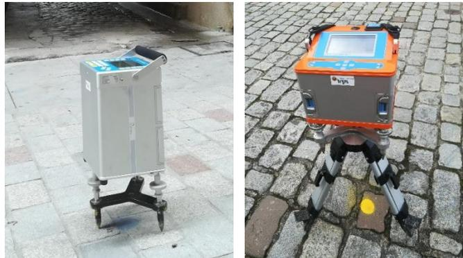
Illustration A1.1 - Photo d'un gravimètre CG-5 sur son trépied bas (gauche) et d'un gravimètre CG-6 sur trépied bas et haut (droite).
