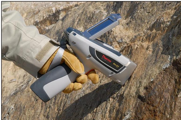
illustration 116 : Exemple d'utilisation du pXRF (Source ThermoFischer)
