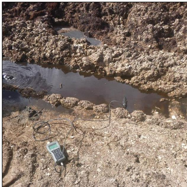
illustration 118 : Analyse des paramètres *in situ* dans les eaux de lixiviation sur le site d'épandage de Gros Cap
