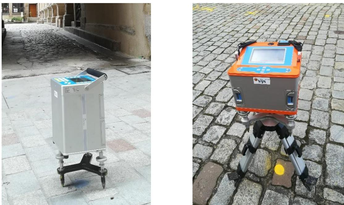
*Illustration 12 - Photo d'un gravimètre CG-5 sur son trépied bas (gauche) et d'un gravimètre CG-6 sur trépied bas et haut (droite)*
