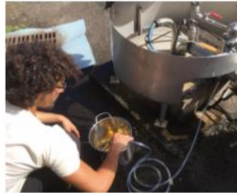
Fig. 7: prélèvements en vue du dosage des CFC et du SF 6 et de la datation des eaux
