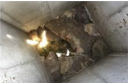
Fig. 6 : couche à conglomérats ou « à papa » interceptée par un puits à Rangiroa
