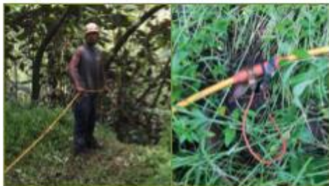
Fig. 4: mise en place d'un dispositif de tomographie électrique dans la vallée de la Papenoo après layonnage et détail d'une électrode
