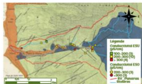
Fig. 3: conductivités électriques de l'eau mesurées au droit du bassin-versant de la Punaruu (ESU = eau superficielle, ESO = eau souterraine)
