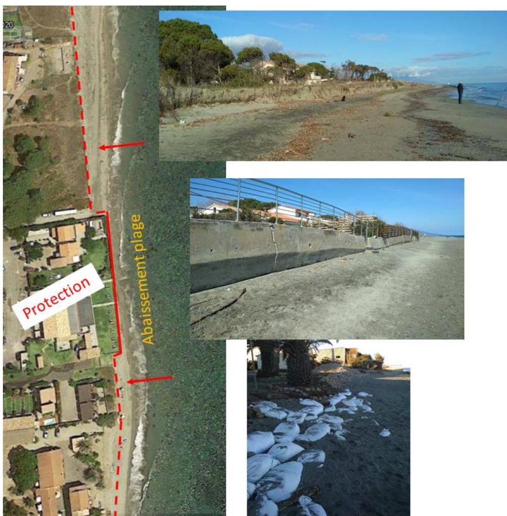
Figure 48 : Exemple d'ouvrage et d'impact (flèches rouge : recul trait de côte) au droit du lotissement Plneto (Commune de Lucciana).
