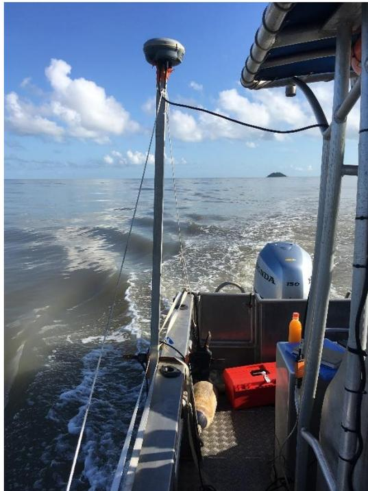
*Illustration 10 : Installation de la sonde monofaisceau mono fréquentiel couplée avec le DGPS.*
