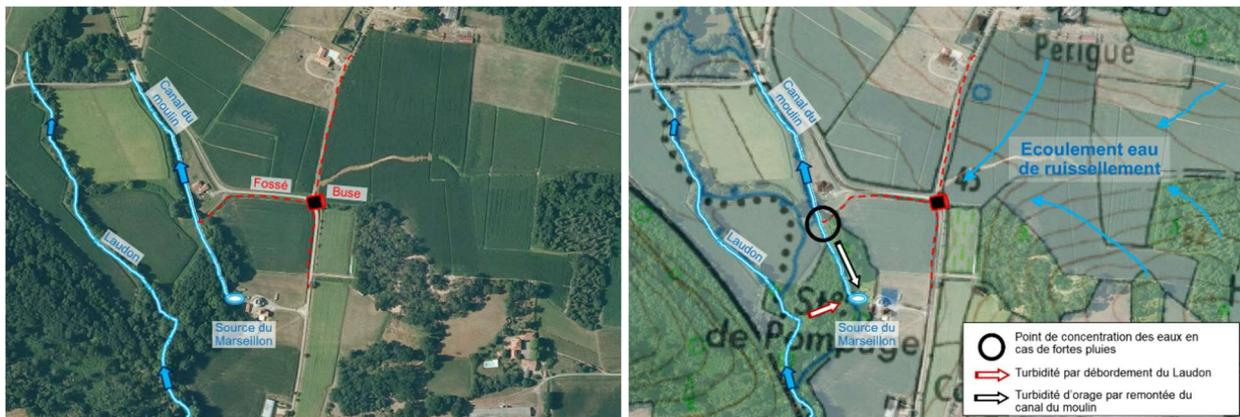
Illustration 60 - Schéma conceptuel d'apparition de la turbidité, dans la source du Marseillon
