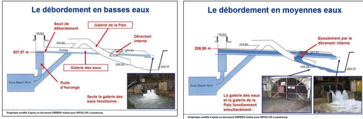
Illustration 12 : Schéma du dispositif de débordement du réservoir Nord (Vaute, 2007)
