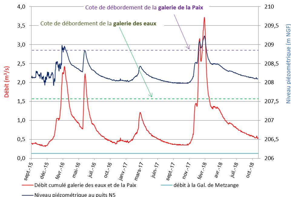
Le niveau du réservoir minier est contrôlé par deux points de débordement situés à la cote 207,57 m (galerie des eaux - N14bis) et 208,85 m (galerie de la Paix). Ses eaux débordent vers la Fensch.
