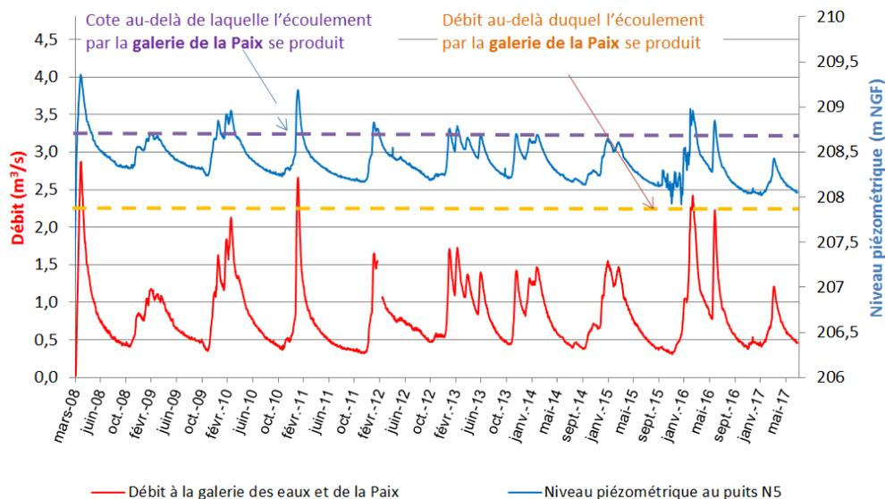
Le réservoir minier présente une grande inertie du fait de son contrôle par les points de débordement situés à la cote 207,57 m (galerie des eaux - N14bis) et 208,85 m (galerie de la Paix).
