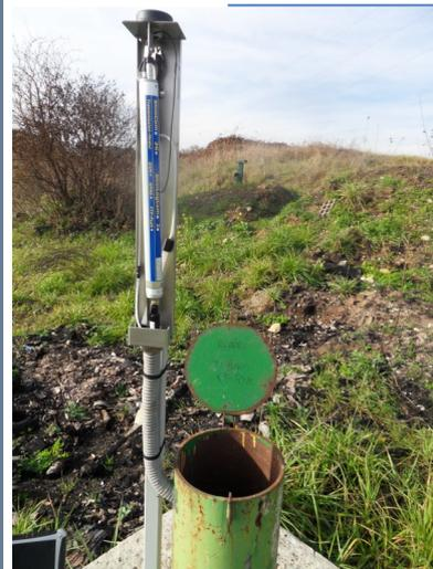
Piézomètre N20 (Fontoy) équipé d'une sonde pression et module de télétransmission
