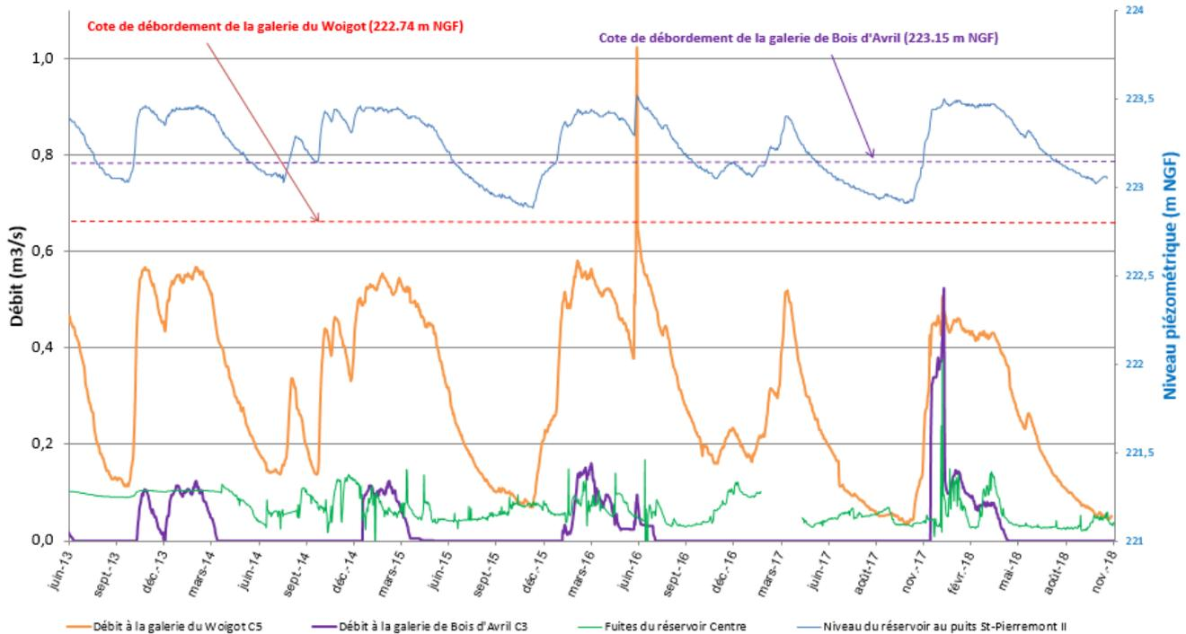
Le réservoir minier présente une grande inertie (battement observé de 0,60 m) du fait de son contrôle par les points de débordement situés à la cote 222,74 m (galerie du Woigot - C5) et 223,15 m (galerie de Bois d'Avril—C3) et des fuites au niveau du Chevillon.
