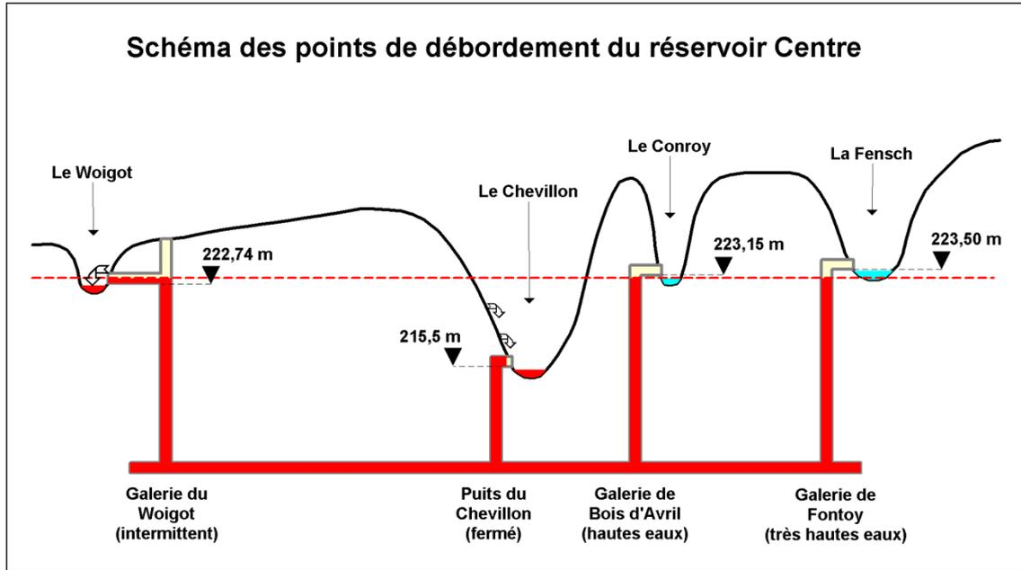
Illustration 15 : Schéma très simplifié du dispositif de débordement du réservoir Centre (Vaute, 2007)
