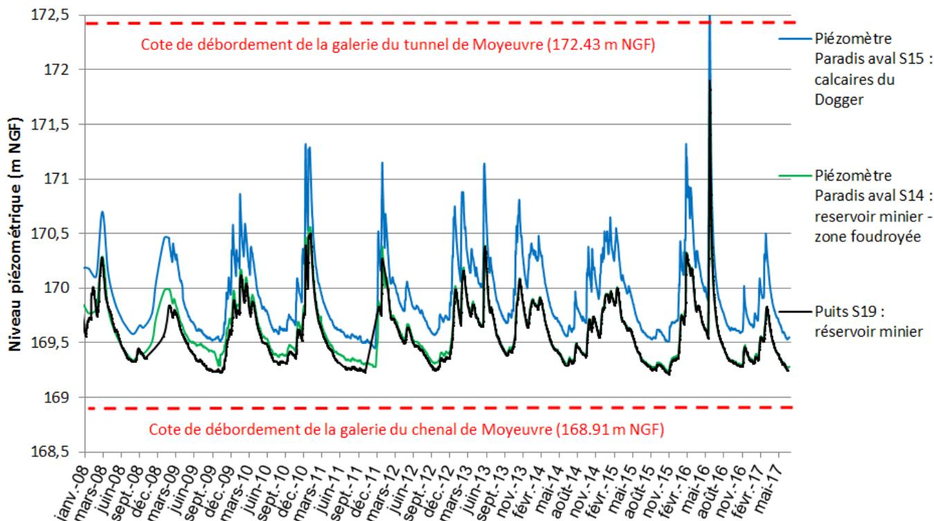
Les conditions de recharge du réservoir minier sont liées aux niveaux piézométriques de l'aquifère des calcaires du Dogger sus-jacent qui l'alimente directement à travers les zones foudroyées. Très réactif à la pluviométrie, l'aquifère du Dogger, mesuré à la station S15, s'est légèrement rechargé avec les précipitations observées en mars. Depuis les niveaux sont en baisse avec des cotes mesurées basses. Le réservoir minier suit la même tendance dans sa partie foudroyée (S14) et au centre (S19).
