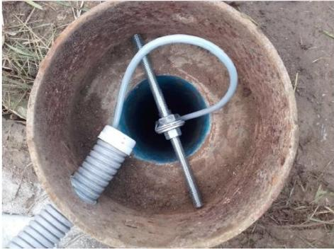
Sonde Dipper et module de télétransmission en place
