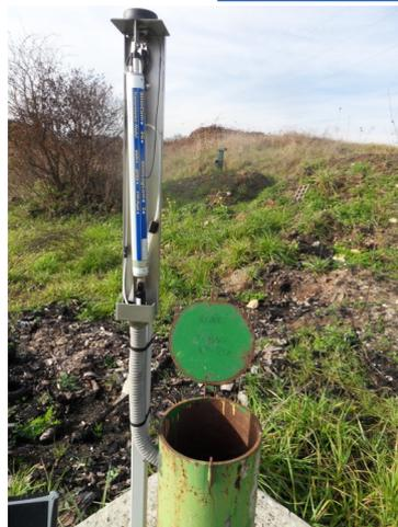
Piezomètre N20 (Fontoy) équipé d'une sonde pression et module de télétransmission
