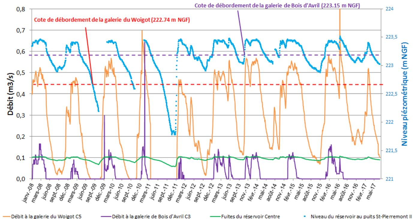
Les écoulements à la galerie de Bois d'Avril se sont interrompus à partir du 8 juillet 2016 et n'ont pas repris depuis. Les écoulements à la galerie du Woigot présentent un débit moyen de  $0,279 \text{ m}^3/\text{s}$ , avec des débits supérieurs à  $0,4 \text{ m}^3/\text{s}$  uniquement au cours du mois de mars. Ils sont descendus en dessous de  $0,2 \text{ m}^3/\text{s}$  depuis fin mai. La cote du réservoir minier présente des niveaux bas, légèrement au dessus de 223 m NGF.
