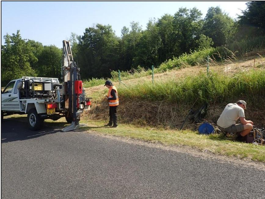
*Illustration 11 - Photographie illustrant le dispositif d'acquisition sismique et la mise en œuvre de la source sismique chute de poids accélérée sur la zone 6 (fontis du Pâquis).*
