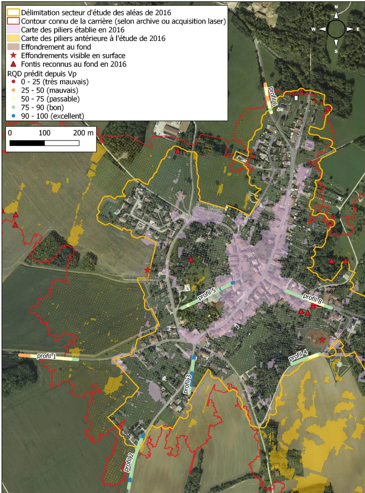
Illustration 47 - Prédiction de la qualité de la roche du calcaire du Portlandien en terme de RQD prédits à partir des mesures de vitesse Vp, suivant le modèle de régression linéaire présenté sur l'illustration 46
