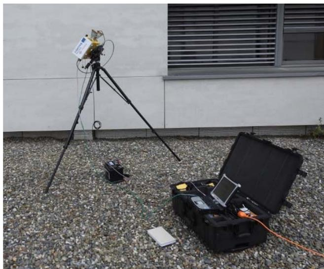
Figure 1: Capteur IBIS en configuration IBIS-S
