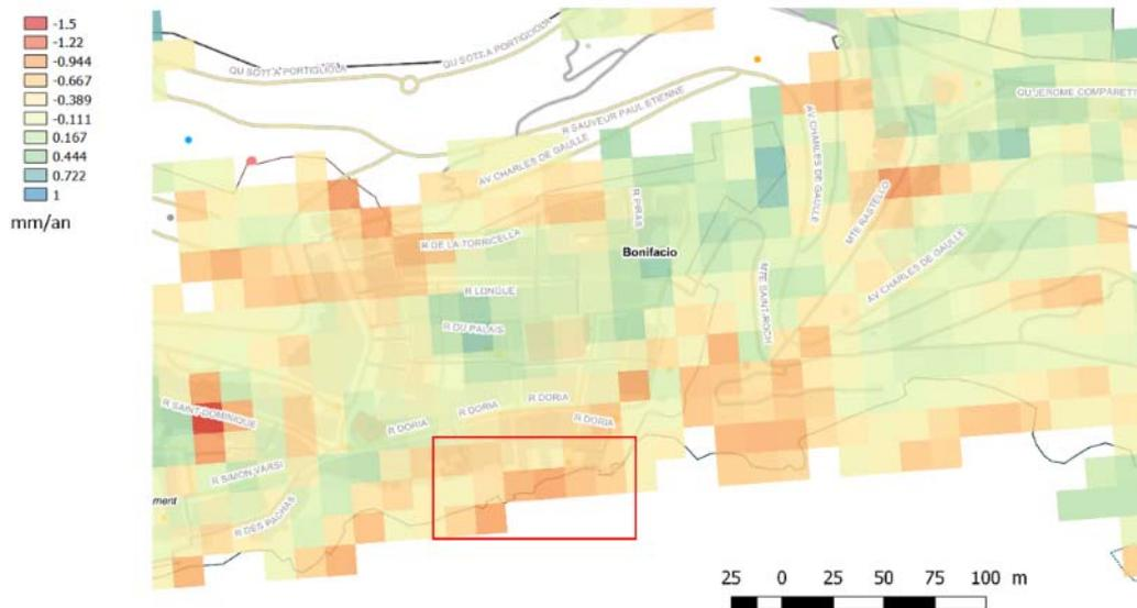
Figure 11 : Carte de déplacements en ligne de visée du satellite. Extrait sur la zone d'intérêt. Le code couleur rouge indique un mouvement d'une portion de la surface s'éloignant du satellite (i.e. subsidence).
