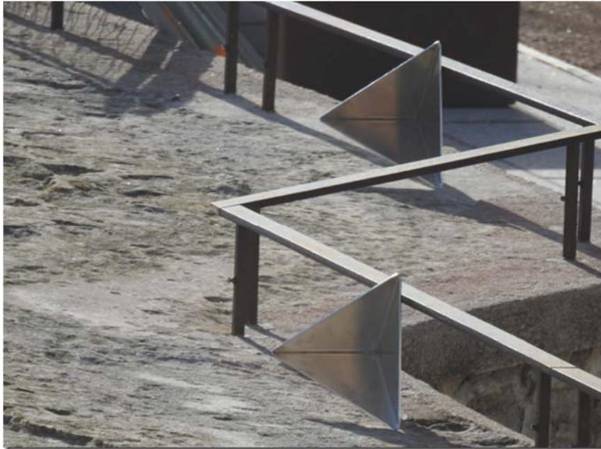
Figure 5 : Vue de cornets réflecteurs (trièdres) fixés sur le mur de la Place du Marché.
