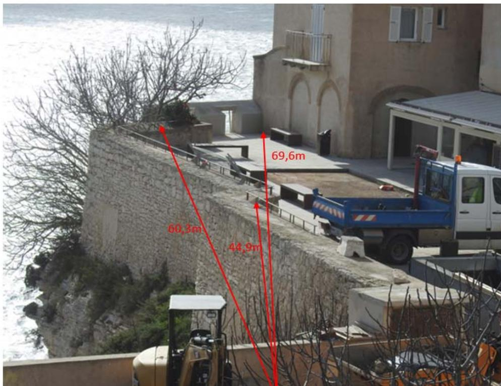
Figure 6 : Distances entre le capteur et certains cornets réflecteurs ainsi que l'angle Sud Ouest de la Place du Marché.
