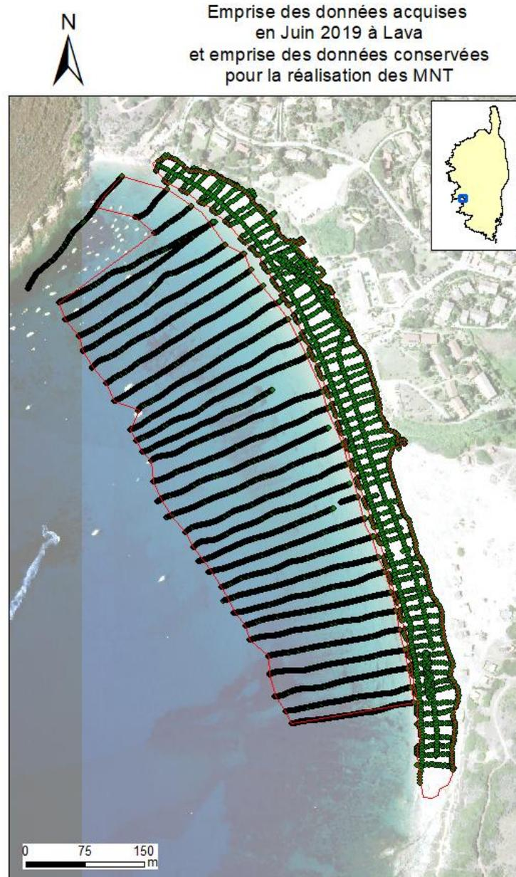
Figure 5 : Ensemble des points levés au DGPS et à l'échosondeur (points verts) et emprises des zones d'interpolation des MNTs (limitées par les polygones rouges. Fond : Orthophotographie © IGN 2016.
