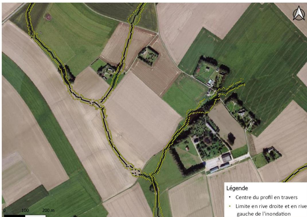
*Figure 27 : Représentation d'un profil en travers après traitement. Chaque profil se résume à trois points : un point pour le centre du profil (avec comme attribut l'altitude de l'inondation) et deux points en rive droite et en rive gauche délimitant la largeur d'inondation.*
