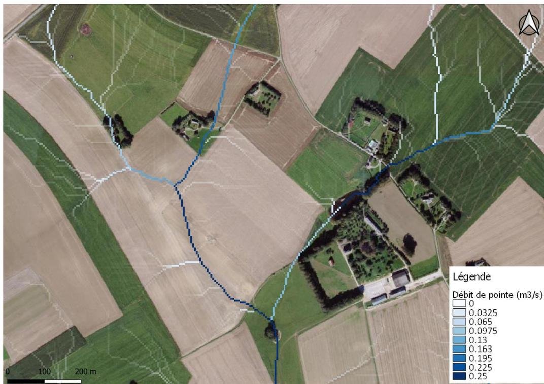
Figure 20 : Exemple de cartographie des débits de pointe en sortie du modèle WaterSed.
