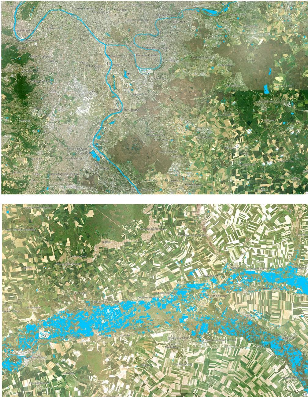
*Illustration 49 – Détection de l'eau (en bleu) avec un processus de seuillage simple (NDWI) issue de l'analyse de l'image Sentinel-2 (datée du 25/02/2018). Au sud de Paris (en haut) et au niveau de la confluence de la Seine et (en bas)*
