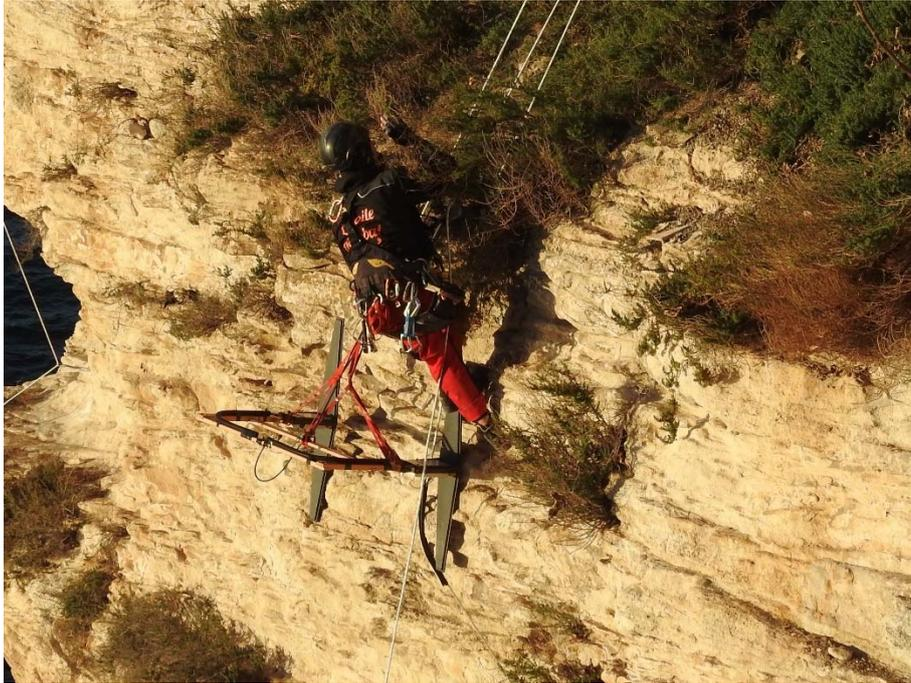
*Illustration 6. Appareillage RAMAC/GPR avec des antennes non blindées de 100MHz sur la falaise .*
