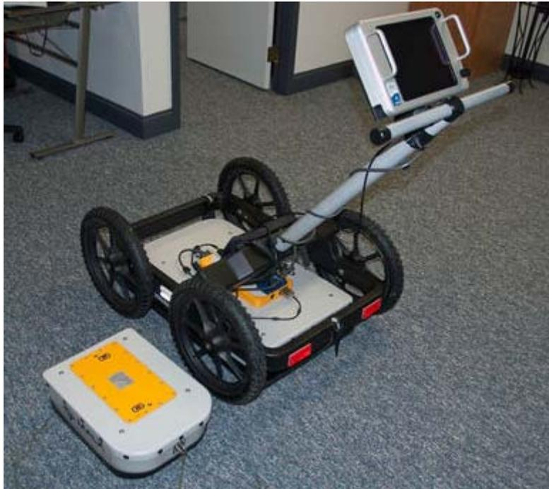
*Illustration 5. Appareillage RAMAC/GPR avec une antenne blindée de 250MHz (dans le chariot) et de 500 MHz. .*
