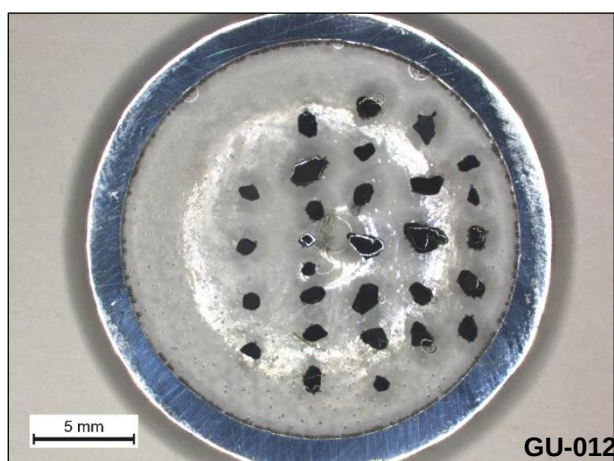
Fig. 6 - Grains de coltan montés en section polie (indice Passoura-Cariacou, échantillon GU-012).
