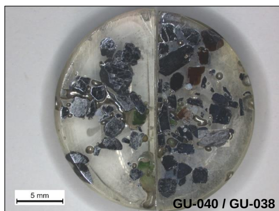
Fig. 5 – Grains de coltan montés en section polie (indices Columbo-Cassegraine, échantillons GU-038 et GU-040).
