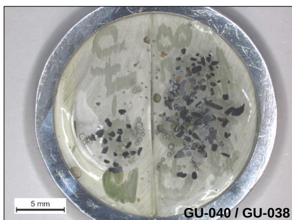
Fig. 5 – Grains de coltan montés en section polie (indices Columbo-Cassegraine, échantillons GU-038 et GU-040).
