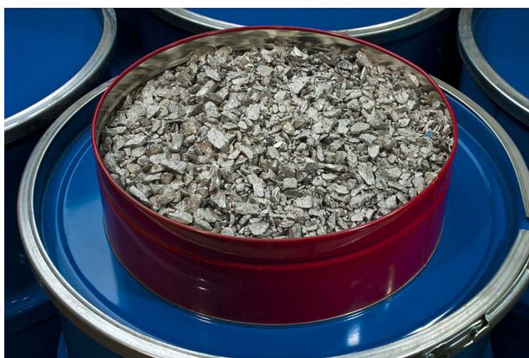
Figure 12 : Alliage de ferro-niobium produit et vendu par la Niobec au Canada ( http://niobec.com ).
