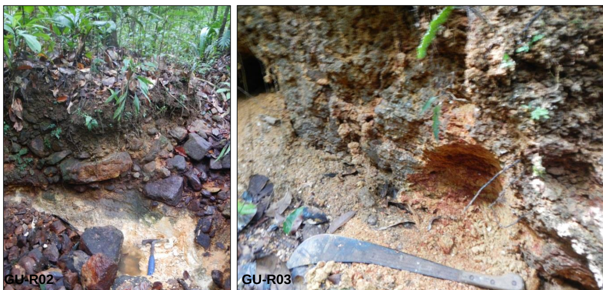
Fig. 7 - Facies pegmatitiques saprolitisés (échantillons GU-R02 et GU-R03).
