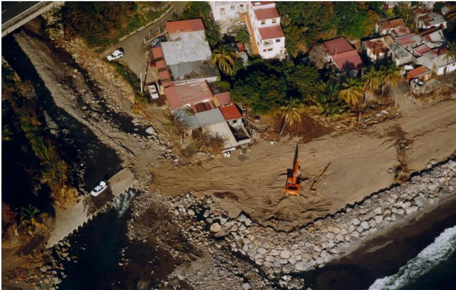
*Illustration 29 – Défluviation au niveau de l'exutoire de la rivière du Galion et érosion de la berge en rive gauche, liée au passage de l'ouragan Lenny ayant généré de fortes pluies en 1999.*
