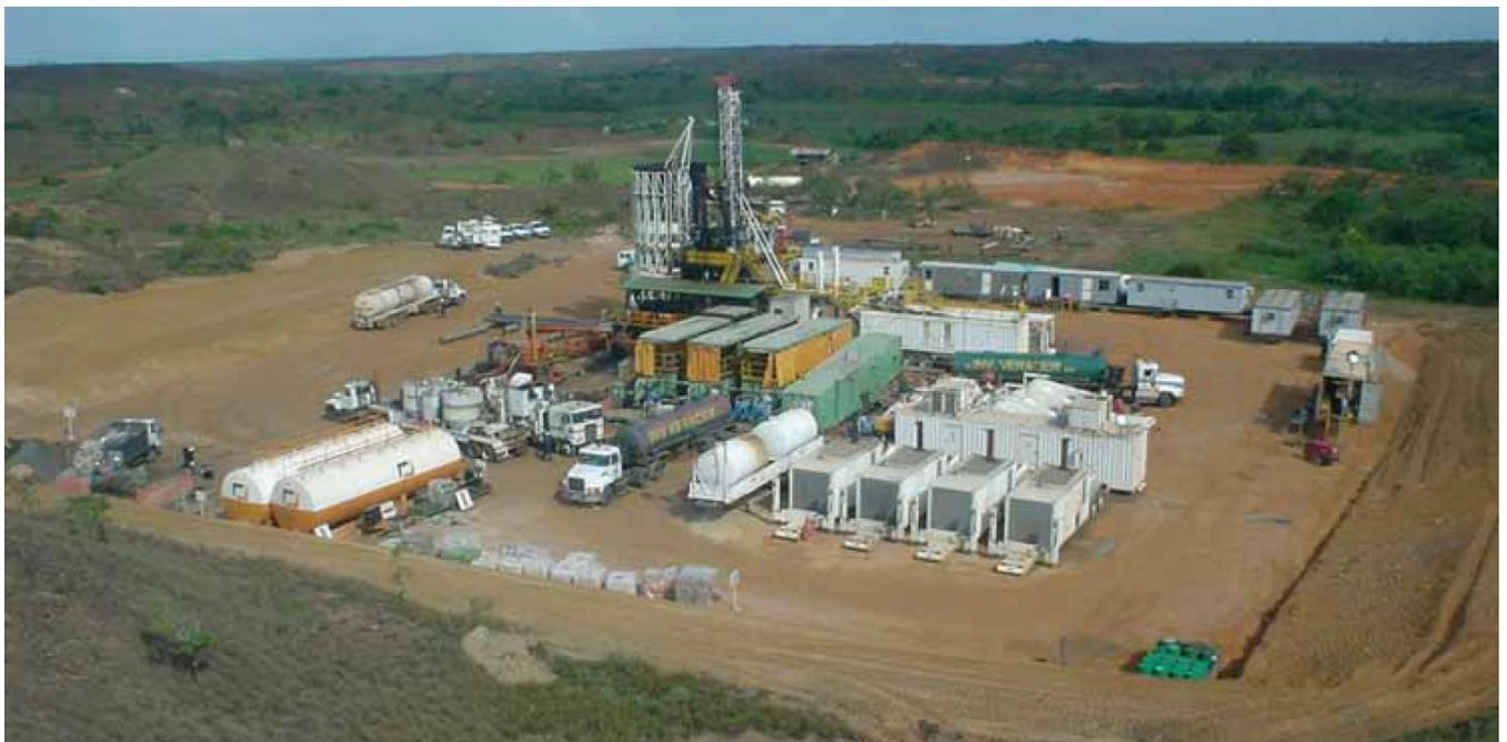
Figure 32 : Vue d'un chantier de forage mettant en œuvre le rig HH102 de Drillmec.
