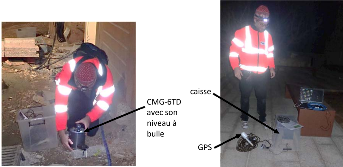
Illustration 2 : Déploiement des sismomètres CMG-6TD le 29/01/2019 dans la Citadelle de Bonifacio
