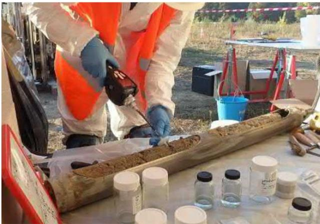
**Mesure sur la gouge** : une mesure au centre de chaque tronçon avant échantillonnage (trou d'environ 1 cm formé dans le sol).
