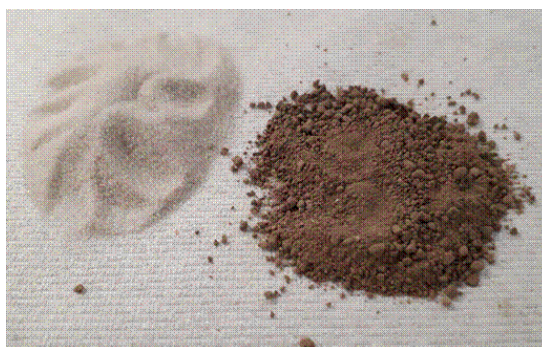
Illustration 1 : Photographie du sable de Fontainebleau (à gauche) utilisé pour l'échantillon G et du sol naturel (à droite) utilisé pour les échantillons A à F.
