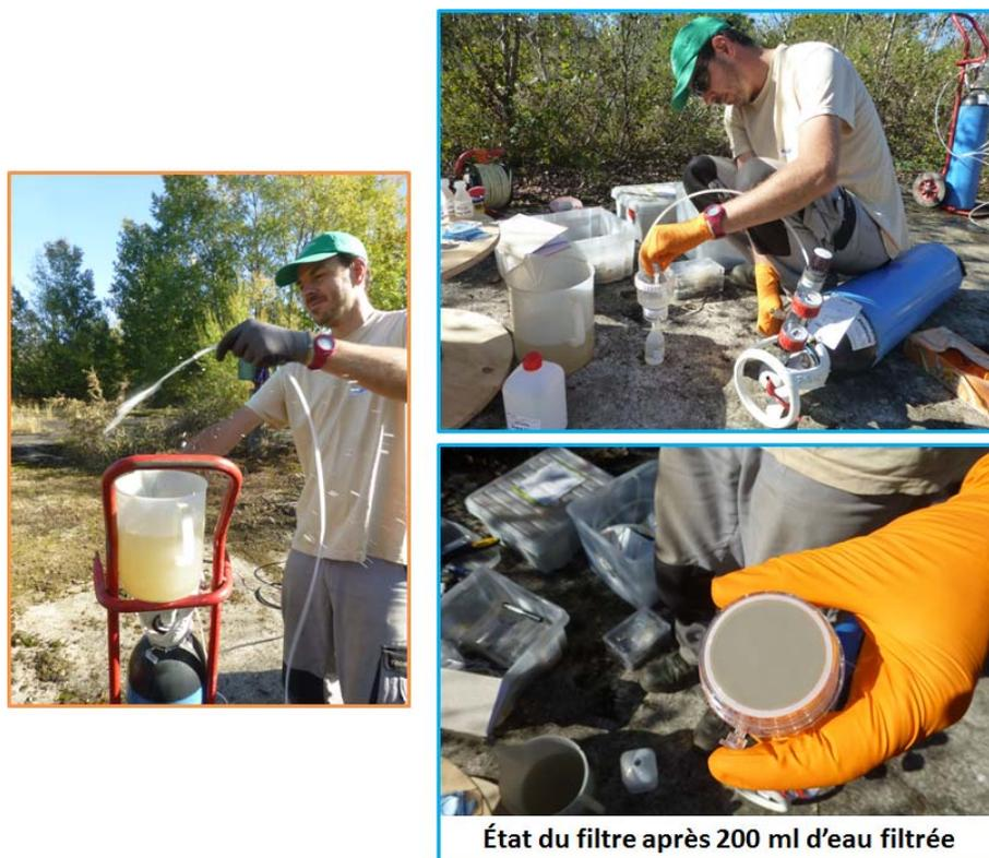
Figure 23 : Remontée d'eau avec préleveur disposé à 425 m, dans le forage de Lacquy, et état du filtre après utilisation.
