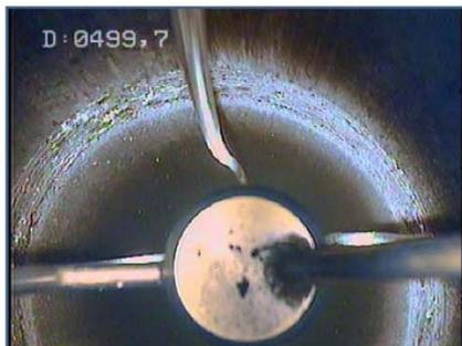
Raccord vissé visible et propre
