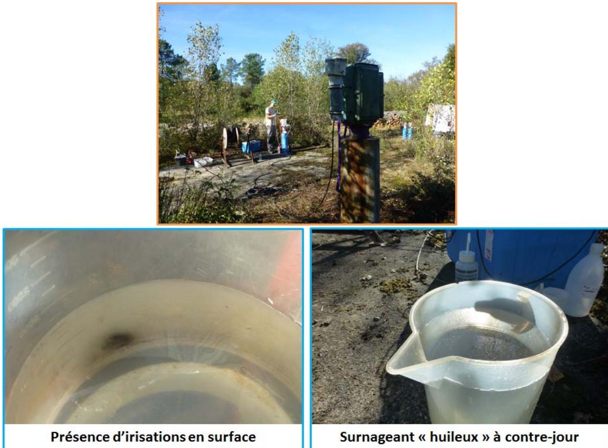
Figure 21 : Première remontée d'eau avec préleveur disposé à 425 m dans le forage de Lacquy : purge de l'eau collectée lors de la descente du système.
