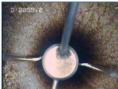
Oxydation visuellement superficielle
