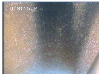
Partie immergée - Oxydation superficielle
