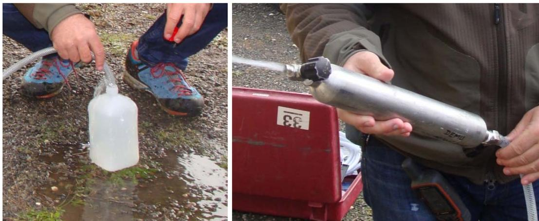
Illustration 60 - Dispositif de prélèvement des eaux pour les mesures de carbone 13 et 14 : à gauche selon une méthode traditionnelle (flacons en polyéthylène) et à droite dans des capsules en inox
