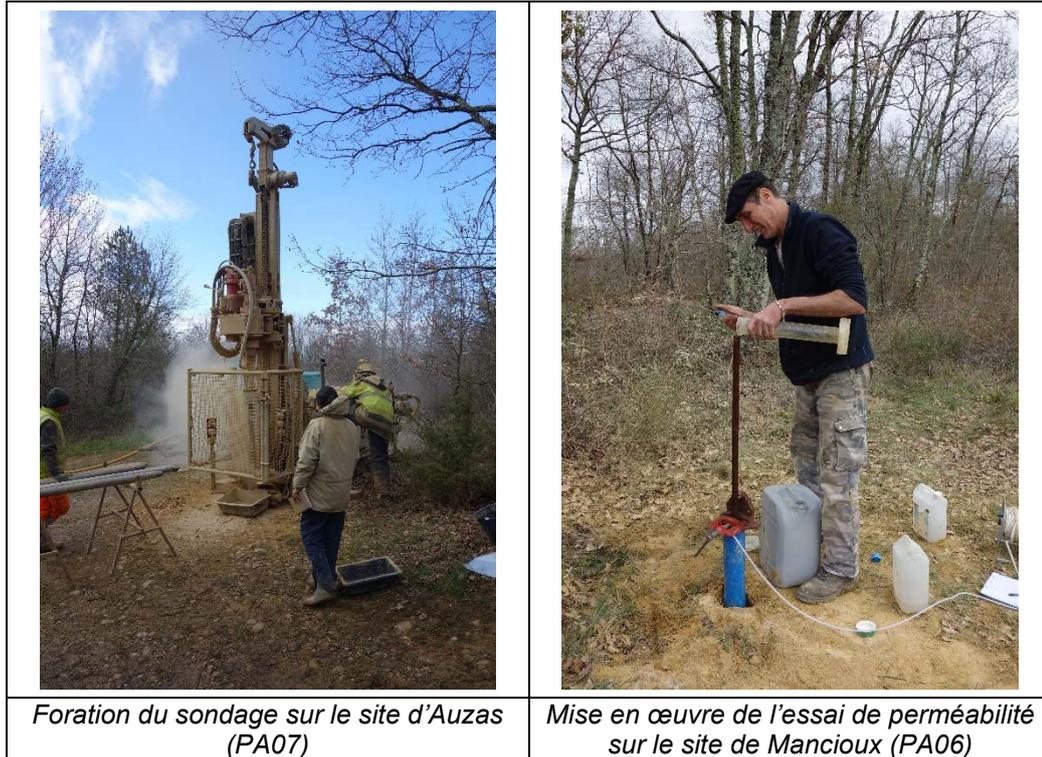
*Illustration 32 - Photographies de mises en œuvre des campagnes de mesures pour la réalisation des essais de perméabilité par la méthode de Nasberg – Terletskata*
