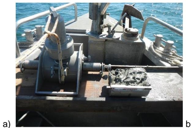
*Illustration 19 : Utilisation de la benne shipeck à l'aide d'une potence à l'avant du bateau (BRGM, 2018).*
