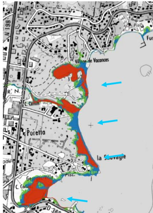
Figure 70 : Exemple du front de mer de Porto-Vecchio au fond du golfe potentiellement submersible par débordement (flèches bleu : entrées d'eau).
