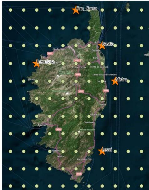
Figure 23 : Grille des données de vagues et vents issues de la base NWW3 Med de la NOAA (ronds verts) et localisation des extractions ponctuelles correspondants aux points les plus proches des bouées CANDHIS ainsi qu’au point utilisé pour la zone d’étude au large de Lecci (étoiles oranges).
