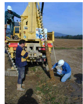
▲ Exemples de sondages à la tarière à main et à la moto-tarière réalisés dans le cadre de la BRAR.
