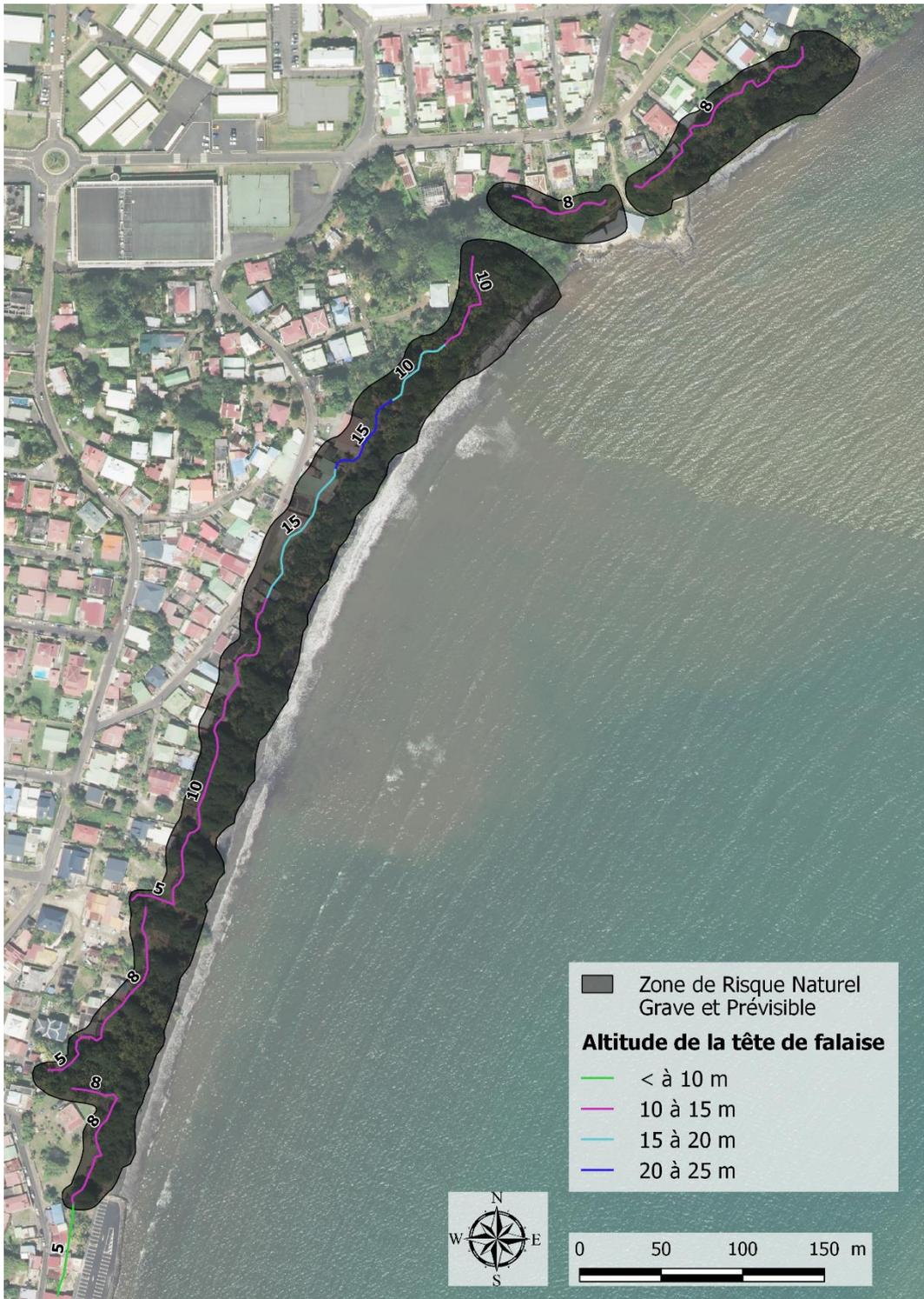
Illustration 41. Cartographie du risque de mouvement de terrain grave et prévisible (emprise grise) sur le site de Bel-Air en fonction de l'altitude de la tête de falaise (polyligne multicolore) et de l'épaisseur des formations mobilisables (chiffres).
