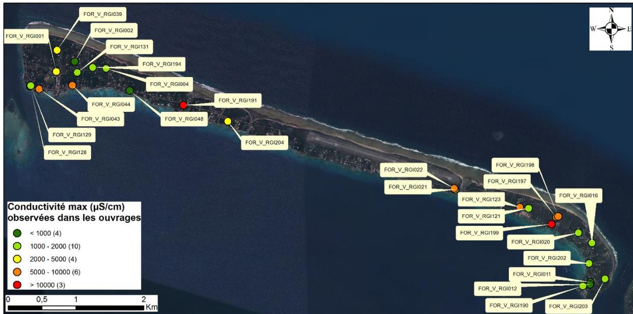
Illustration 9 : Valeur maximale de conductivité observée sur les 27 ouvrages ayant fait l'objet de logs.
